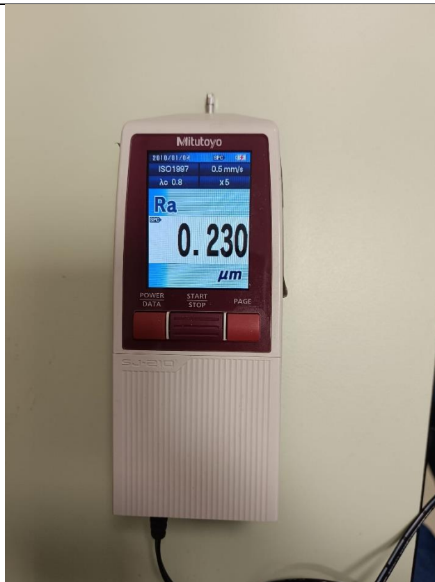
Slika 27. Mjerenje hrapavosti Ra
