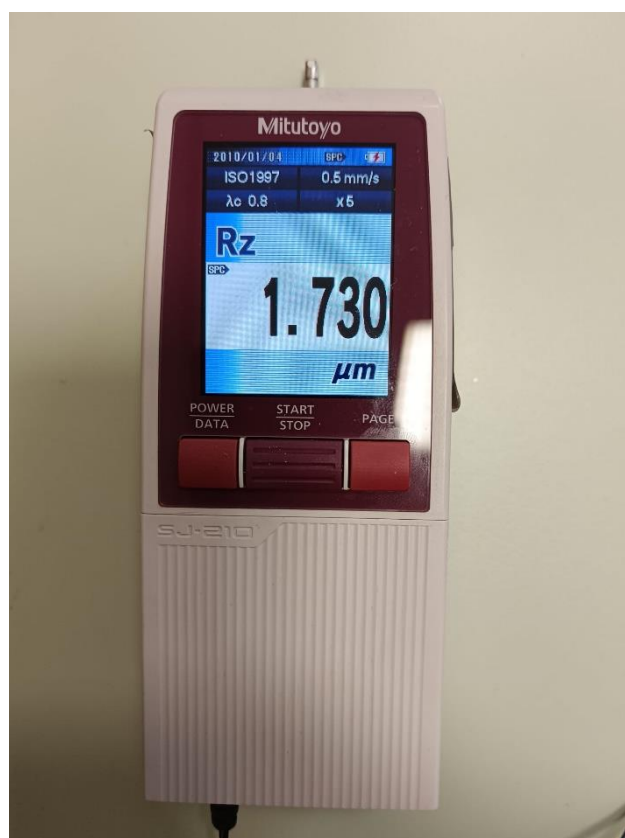
Slika 27. Mjerenje hrapavosti Ra
