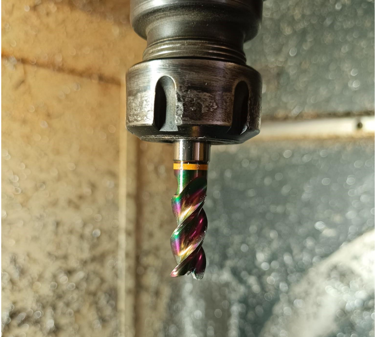
Slika 21. Vretenasto glodalo od tvrdog metala
