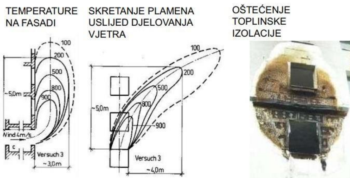
Slika 6. Temperature i trag čađavog vijenca [9]
