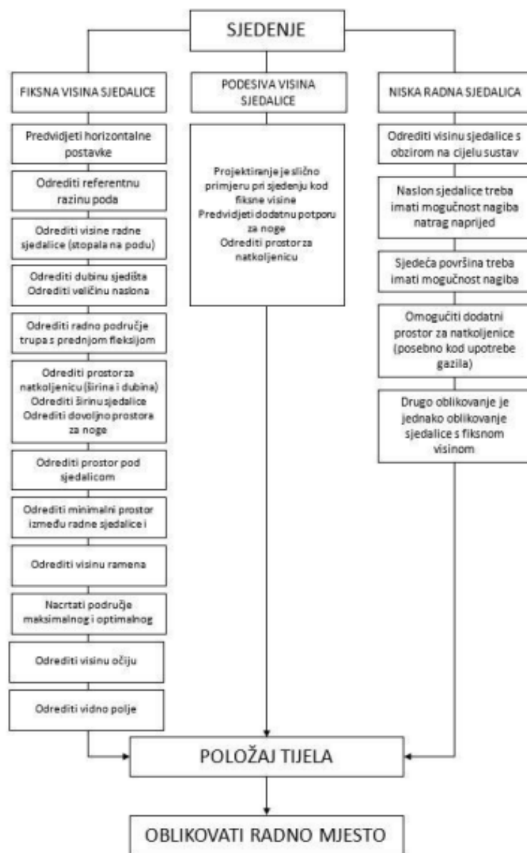
Slika 5. Prikaz načina oblikovanja radnog mjesta temeljem visine radne sjedalice [1]
