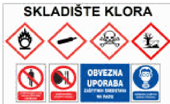
[14] oznake i upozorenja za skladište klora
