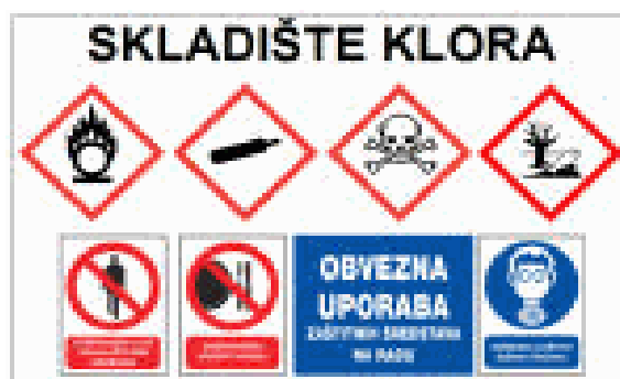
[14] oznake i upozorenja za skladište klora
