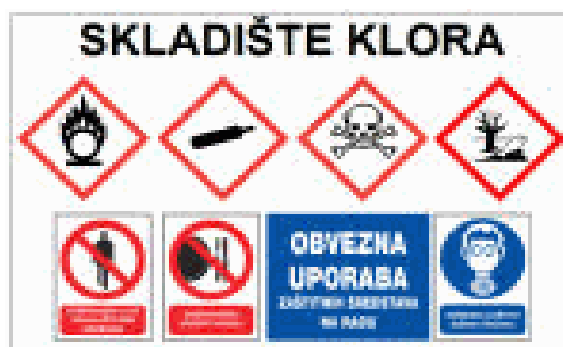
[14] oznake i upozorenja za skladište klora
