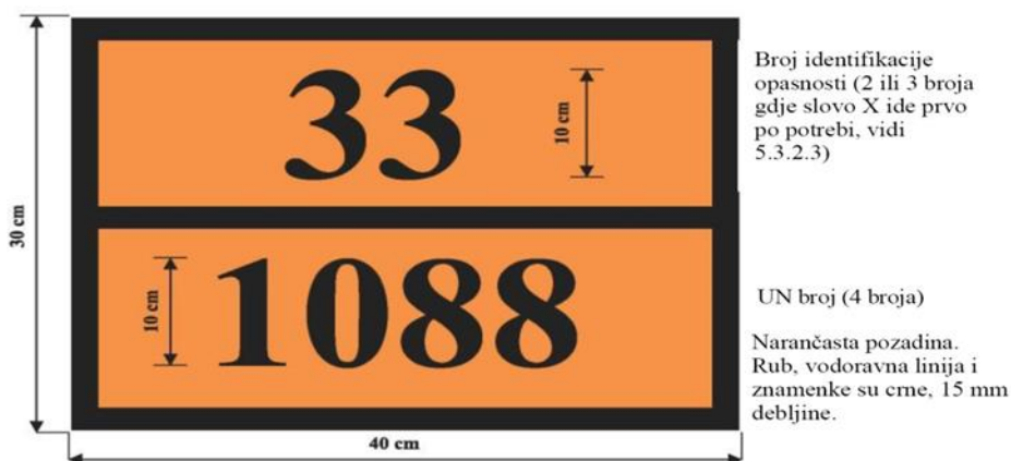
Slika 5. Ploča s brojem za raspoznavanje opasnosti(gore), i UN- brojem tvari (dolje)
