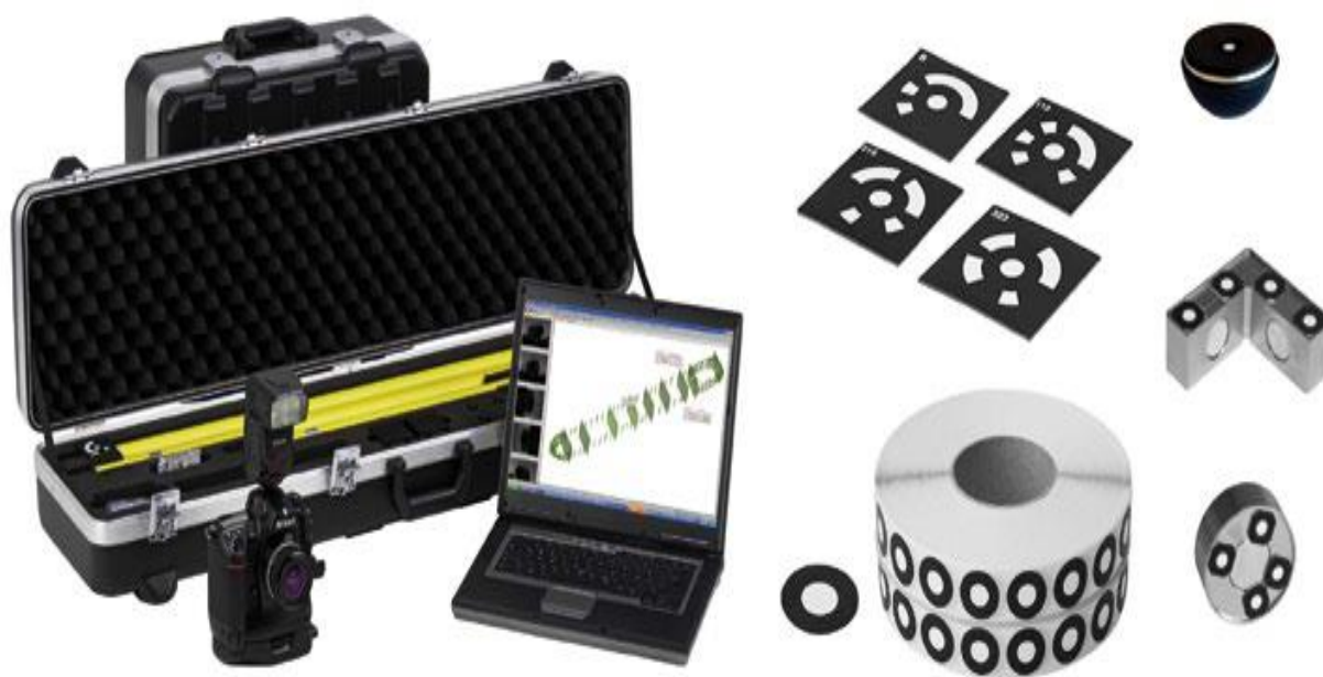
Slika 19. Oprema za fotogrametriju Tritop
