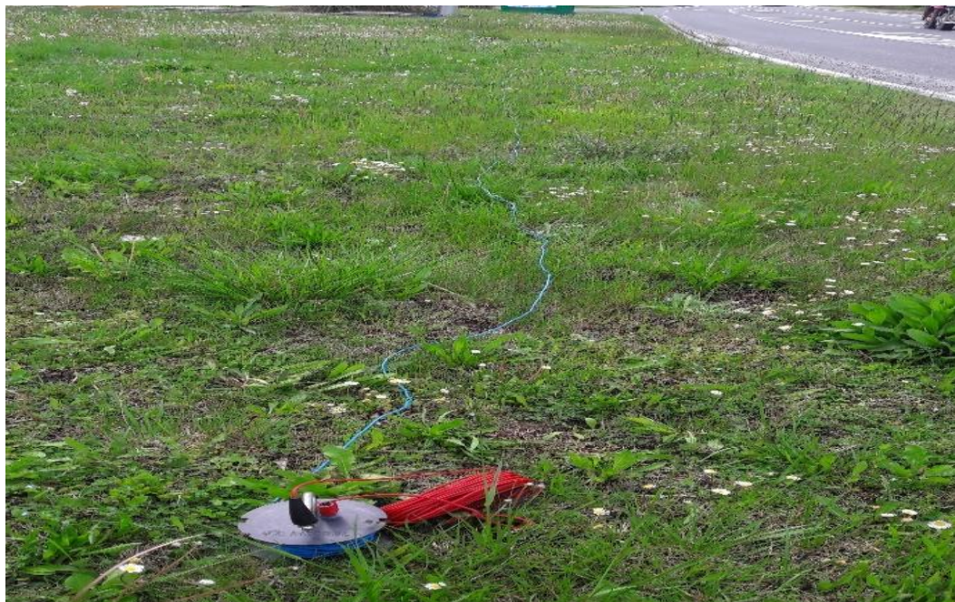
Slika 22. Sonde zabijene u tlo zbog ispitivanja gromobrana [26]
