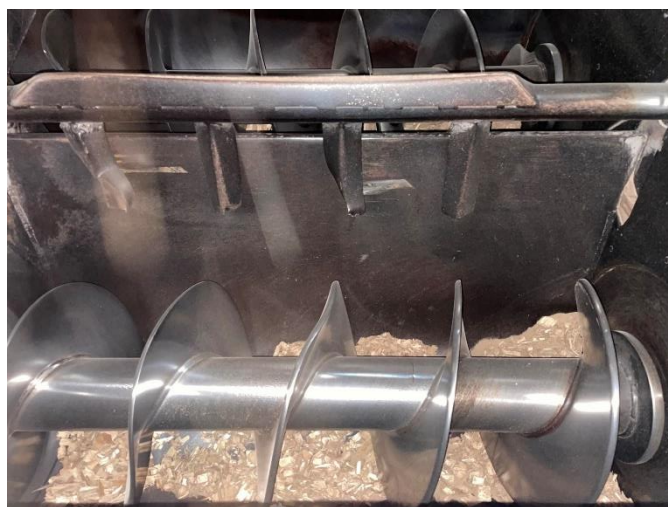
Slika 6. Razdjelni transportni puž [5]
