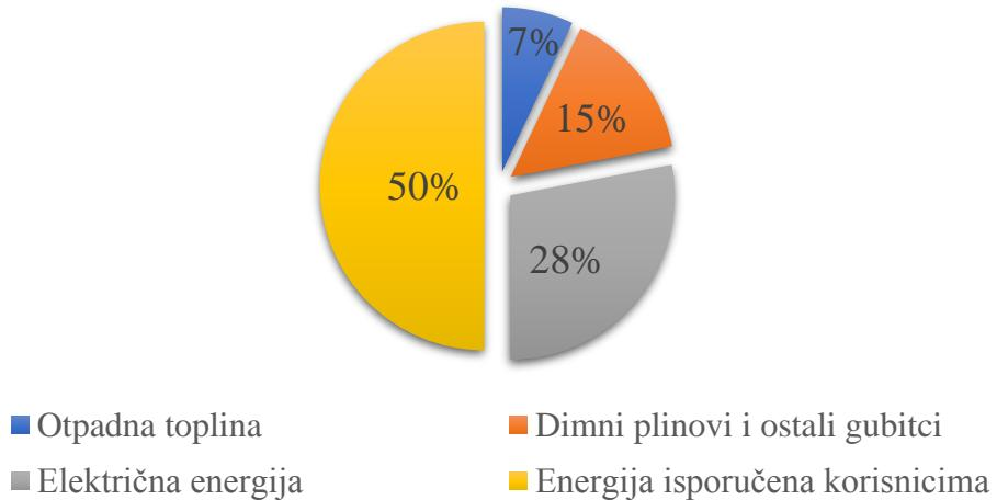
Slika 2.Postotci nastale električne i toplinske energije u kogeneracijskom postrojenju [1]
