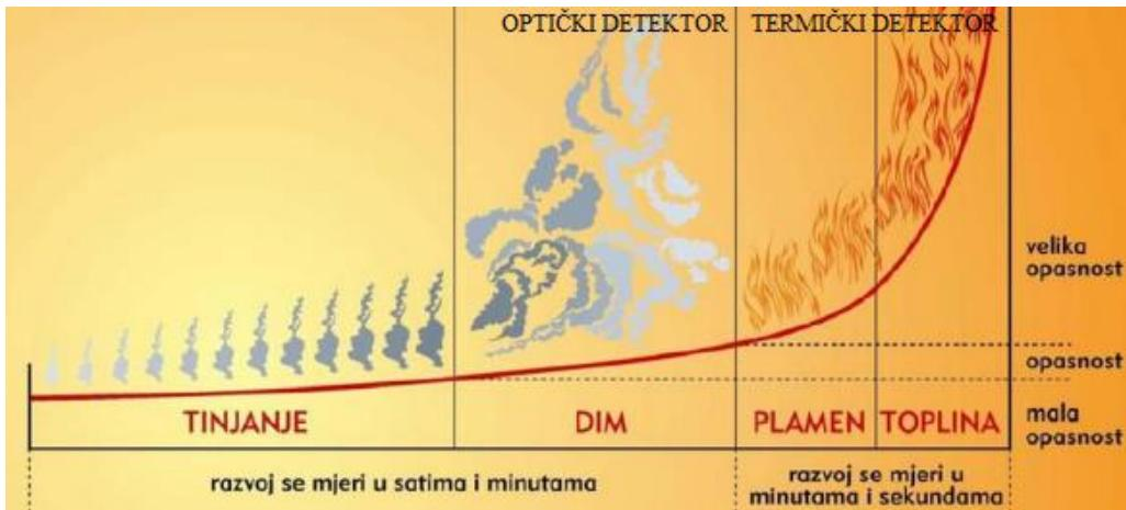
Slika 24. Proces razvijanja požara i odgovarajuća vrsta detektora [15]
