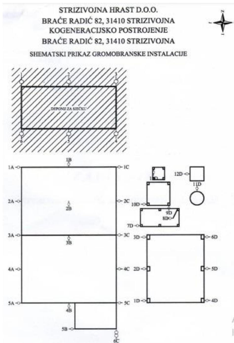
Slika 39. Gromobranska instalacija kogeneracijskog postrojenja i deponije za sjećku [7]
