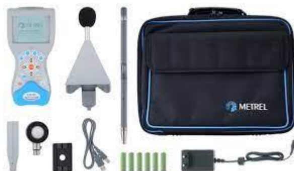
Slika 11. Bukomjer Metrel Multinorm MI 6201
