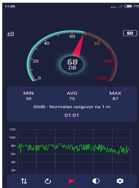
Slika 10. Prikaz mjerenja aplikacijom Mjerač zvuka u trajanju od 60s (1 min.) [28]
