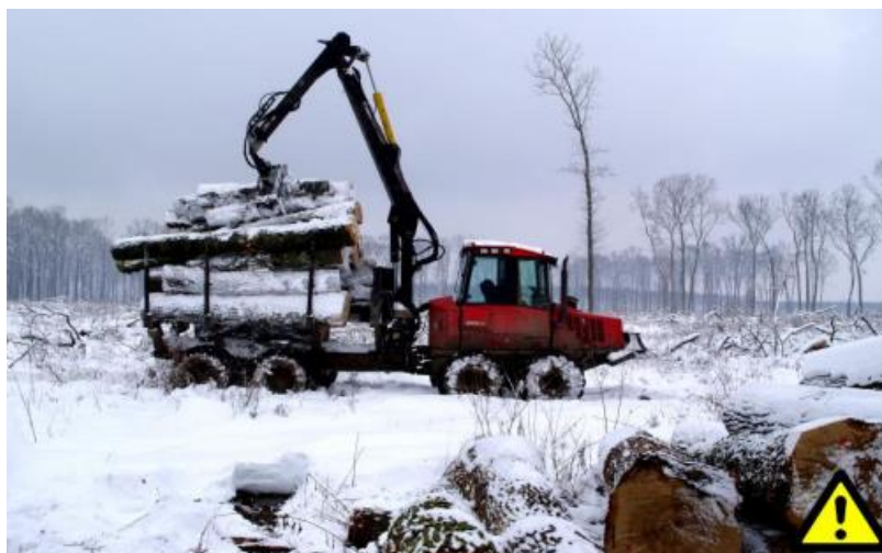
Slika 11. – nepravilno utovaren forwarder
