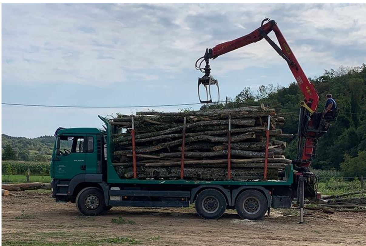
Slika 12. – tovarjenje drvnog sortimenta na pomoćnom stovarištu
