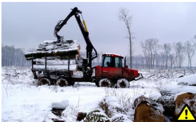
Slika 11. – nepravilno utovaren forwarder
