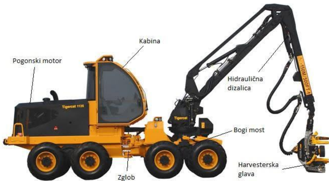
Slika 6. – Prikaz osnovnih dijelova harvestera
