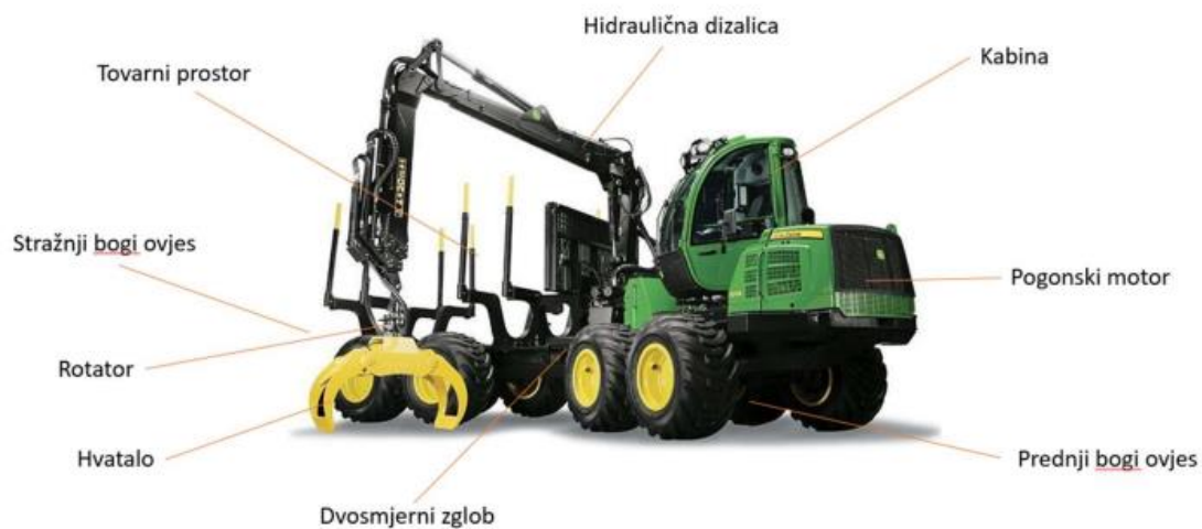
Slika 10. – prikaz dijelova forwardera
