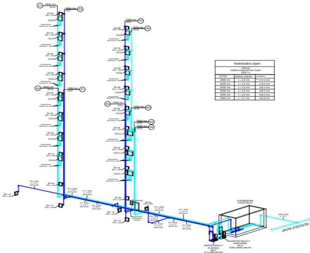
Slika 18. Shema razvodnog vodovoda stambene zgrade [8]
