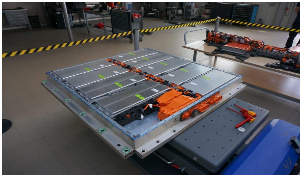
Slika 9. Demontaža li-ion baterije iz električnog automobila
