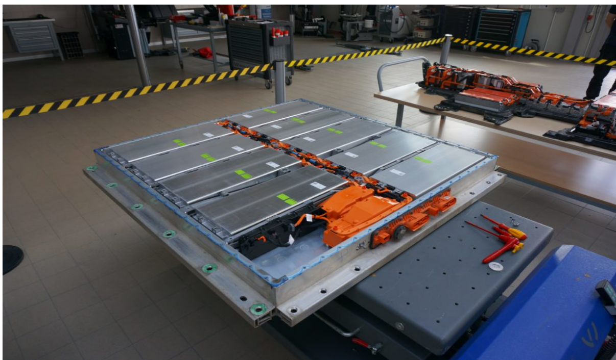
Slika 9. Demontaža li-ion baterije iz električnog automobila
