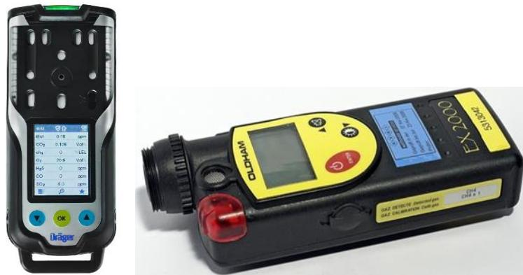
Slika 15: Primjer kemijskog detektora(lijevo)[20] i eksplozimetra(desno) [21].
