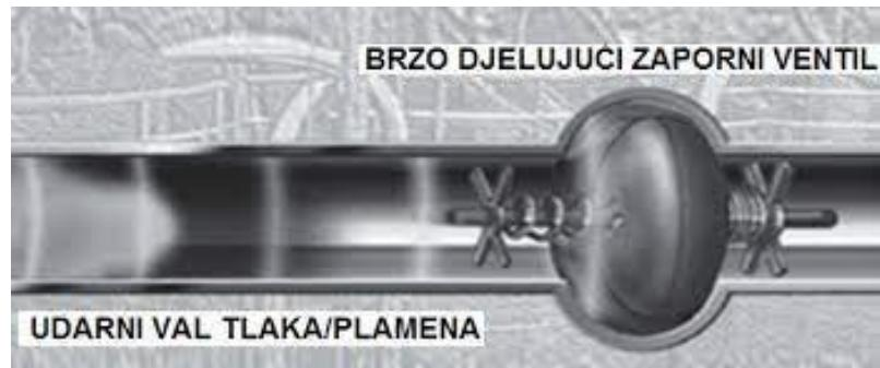
Slika 9: Primjer izoliranja eksplozije sa brzo djelujućim ventilom [7].
