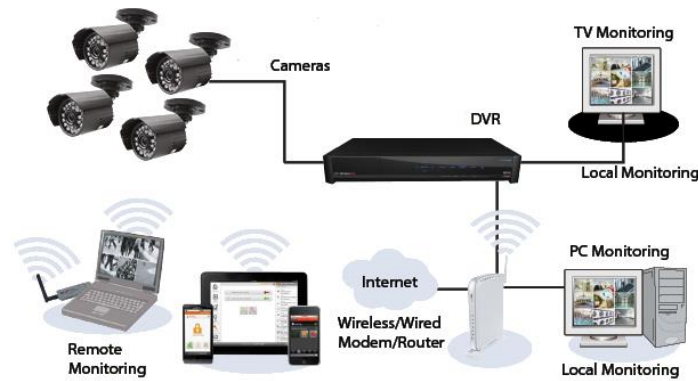
Slika 9. Predodžba sustava videonadzora [32].
