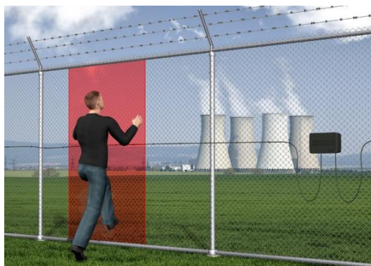
Slika 11. Predodžba sustava zaštite ograde [34].
