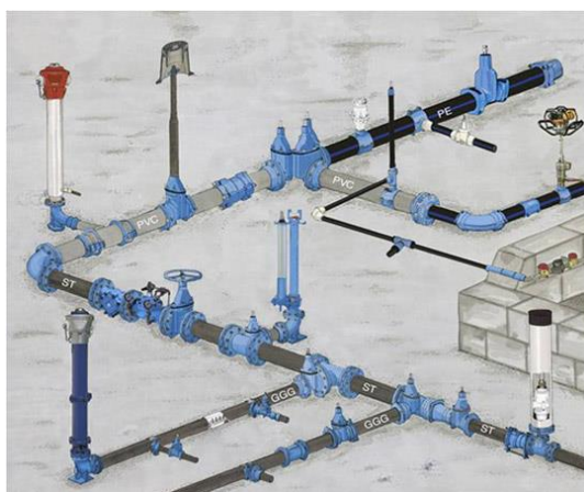
Slika 24. Predodžba vanjske hidrantske mreže [47].
