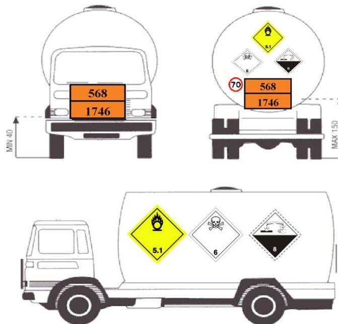
Slika 10: Pravilno označeno vozilo za prijevoz Bromov(III) – fluorid-a [13].
