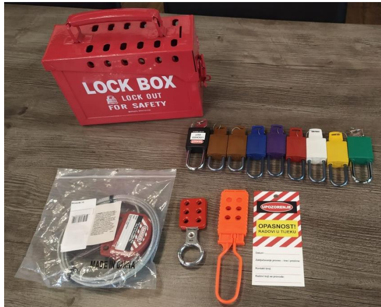
Slika 24. Oprema za LOTO (zaključaj i označi)
