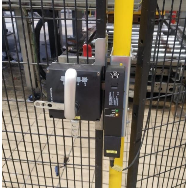
Slika 16. Sigurnosna brava i zaštitna ograda paletizatora
