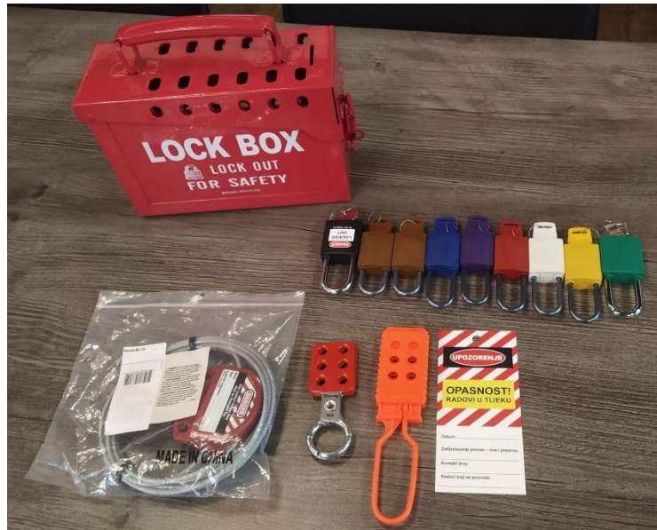
Slika 24. Oprema za LOTO (zaključaj i označi)
