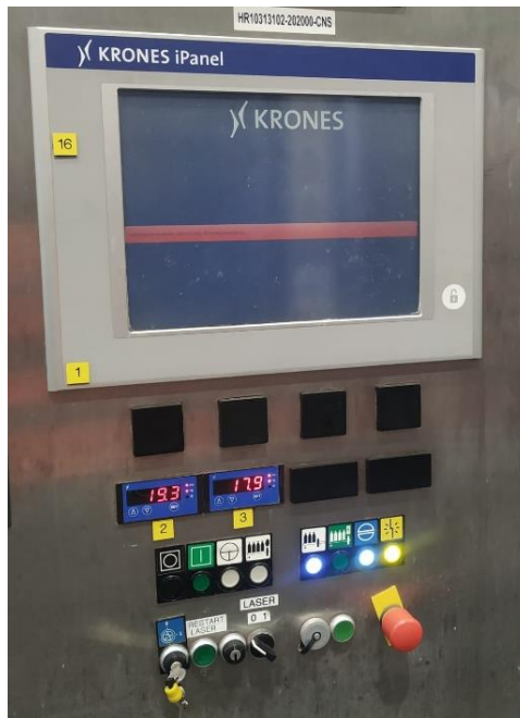
Slika 18. Centralna upravljačka jedinica s prekidačem u slučaju nužde
