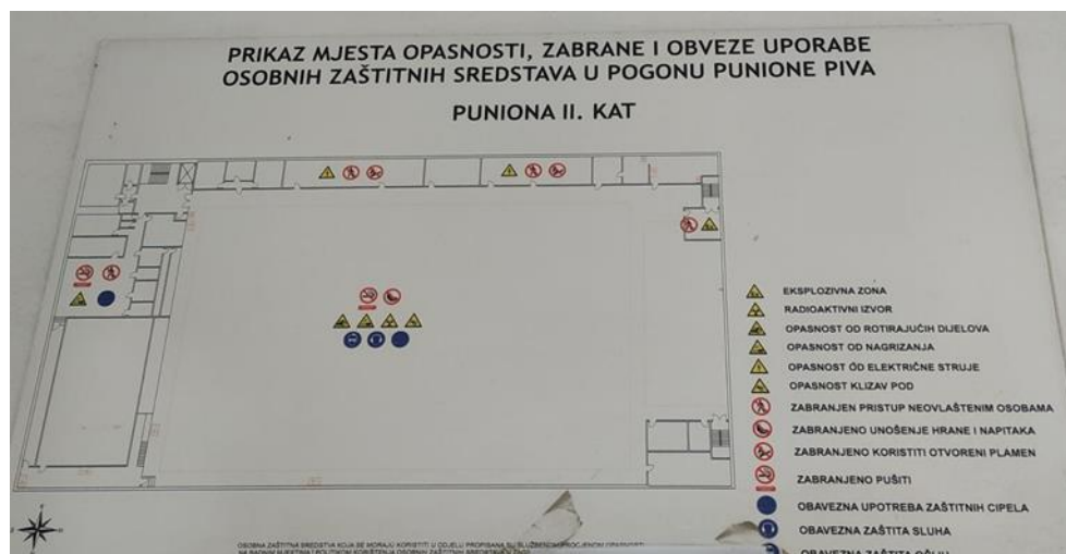
Slika 30. Prikaz mjesta opasnosti, zabrana i obveza u pogonu punionice
