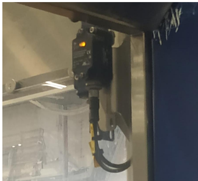
Slika 19. Sigurnosni prekidač unutar stroja
