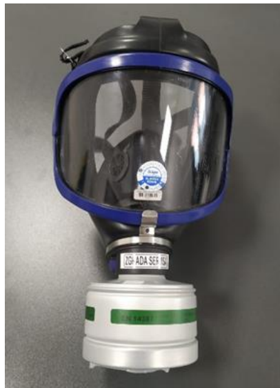
Slika 35. Zaštitna maska za amonijak s filterom
