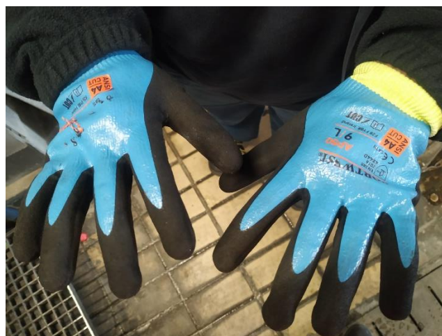
Slika 38. Zaštitne rukavice prilikom rukovanja sa staklom
