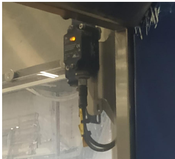
Slika 19. Sigurnosni prekidač unutar stroja
