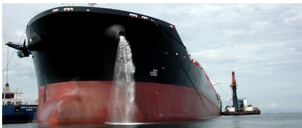
Slika 3. Prikaz iskrcaja balastne vode
