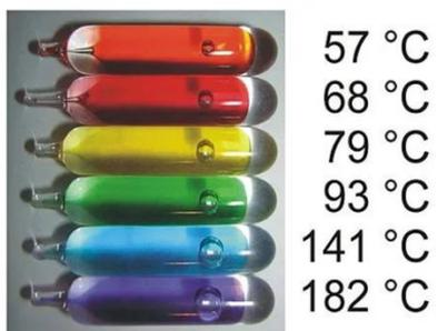
*Slika 8. Prikaz staklene ampule, temperatura aktiviranja raspoznaje se po boji ampule
