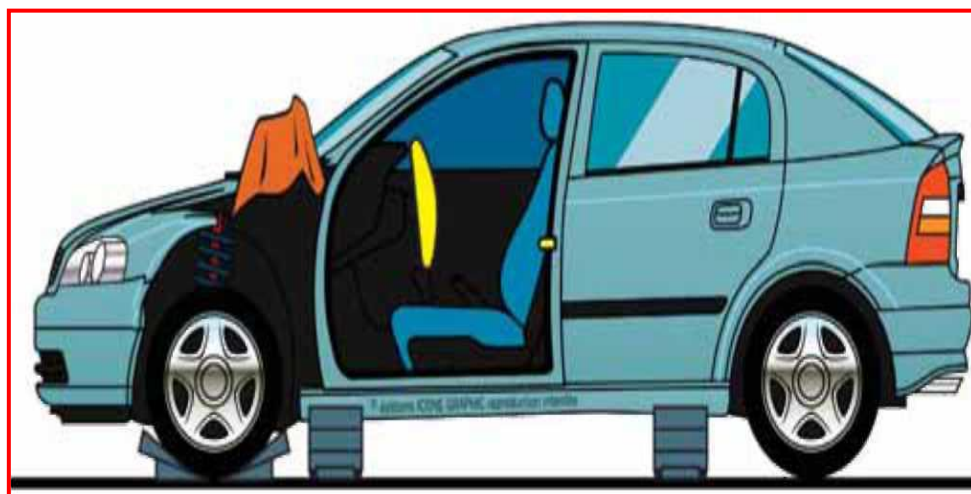
Slika 16. Uklanjanje vrata sa vozila [2]
