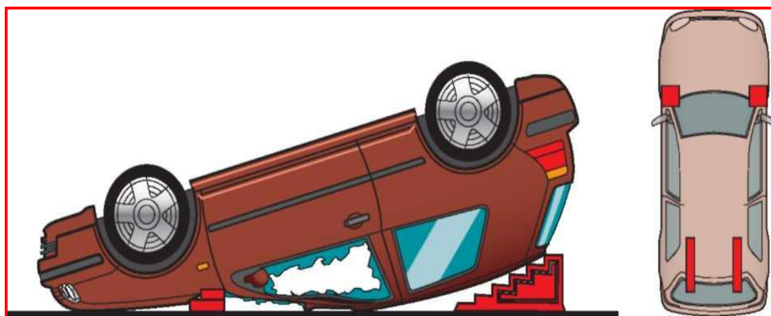
Slika 11. Stabilizacija vozila na krovu [2]
