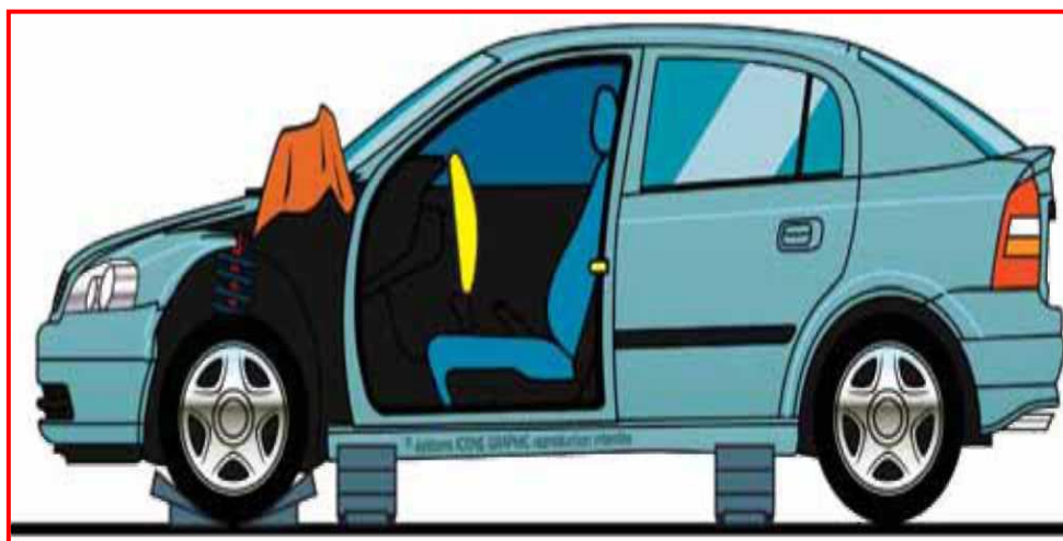
Slika 16. Uklanjanje vrata sa vozila [2]
