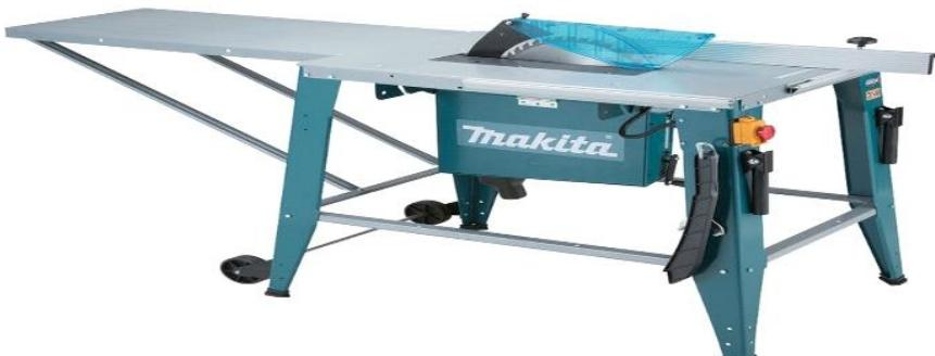
Slika 3. Stolna kružna pila
