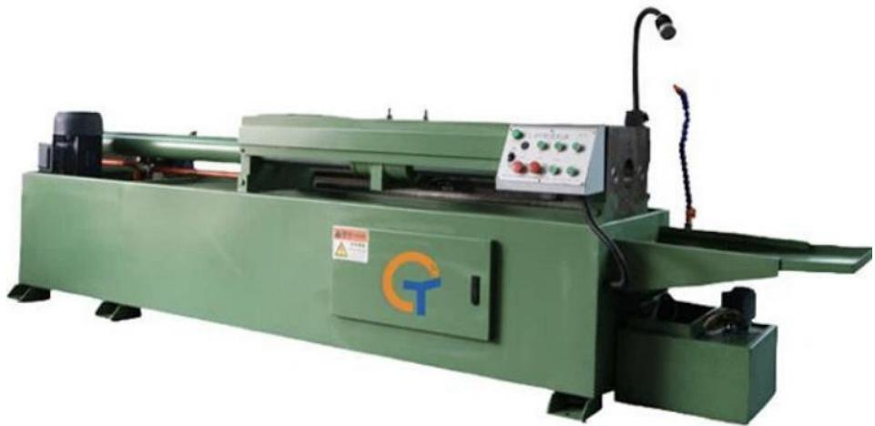
Slika 10. Horizontalni kovački stroj [12]
