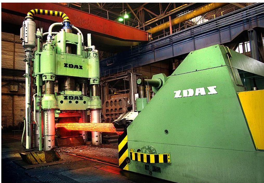
Slika 7. Hidraulička kovačka preša [11]
