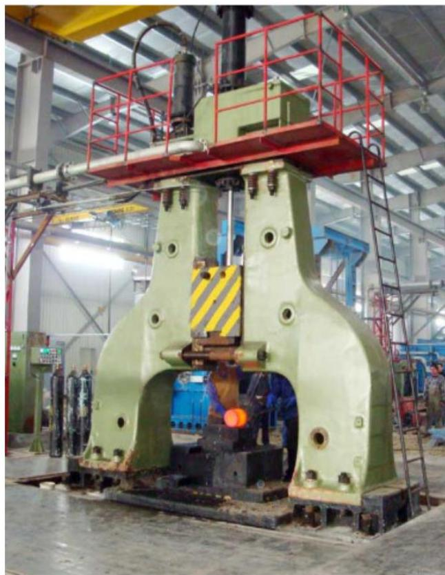
Slika 5. Dvoradni pneumatski bat [5]
