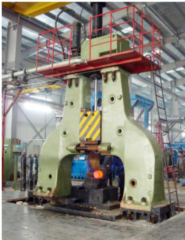
Slika 5. Dvoradni pneumatski bat [5]
