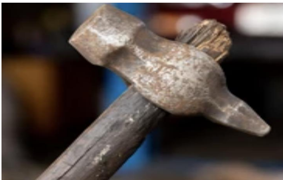
Slika 16. Neispravan ručni alat [16]
