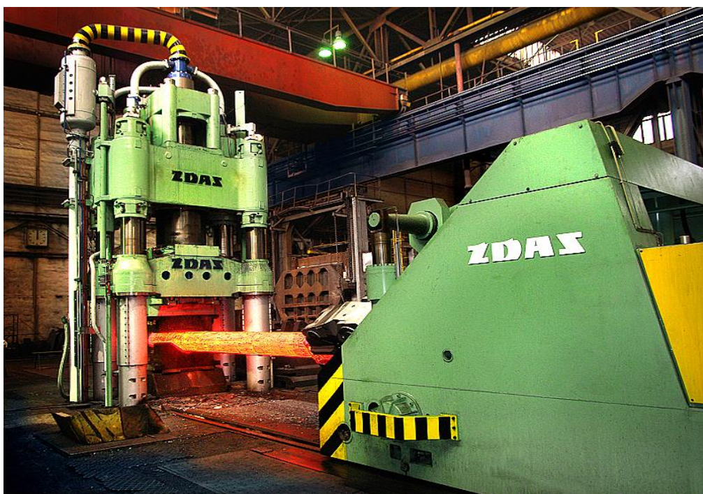
Slika 7. Hidraulička kovačka preša [11]
