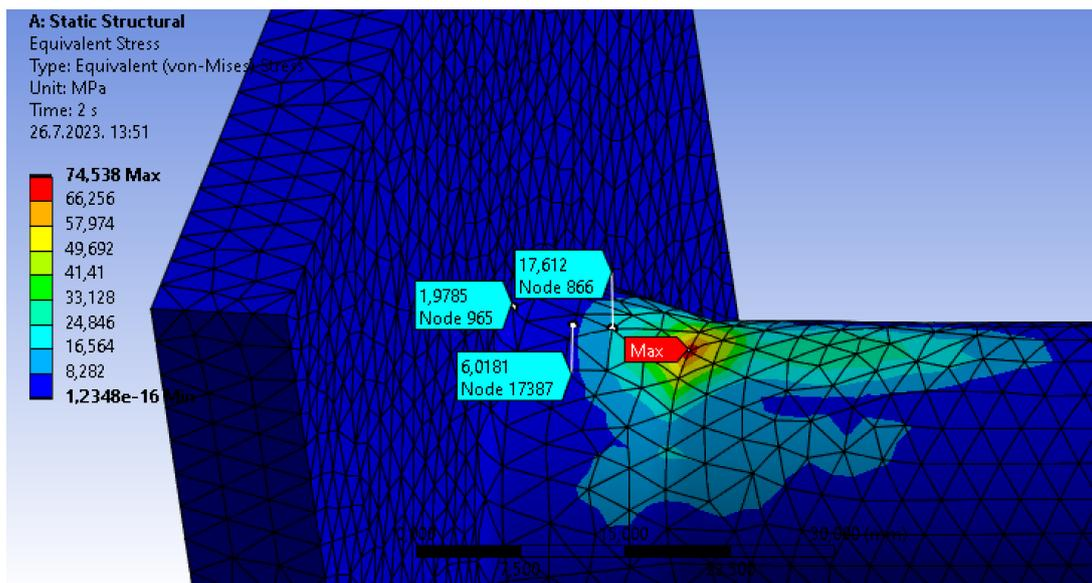
Slika 32. Raspodjela koncentracije naprezanja prilikom savijanja
