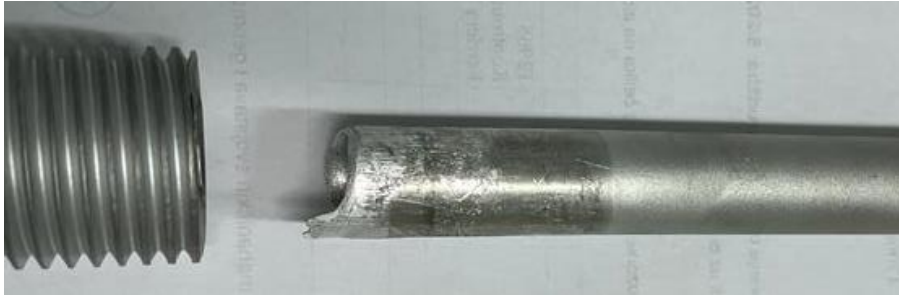
Slika 12. Puknuće ispitnog uzorka
