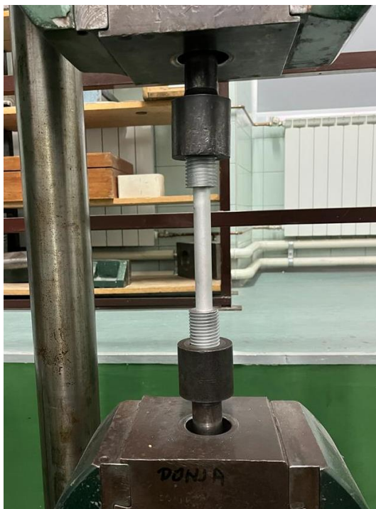
Slika 11. Prihvat uzorka na kidalici
