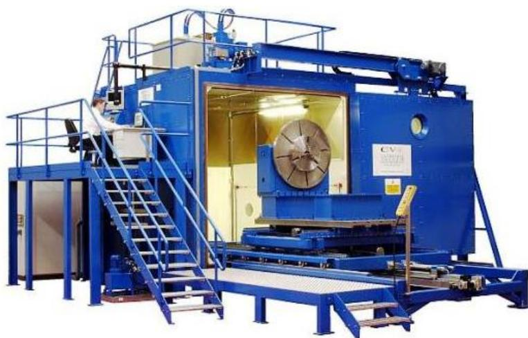
Slika 4. Komora za zavarivanje elektronskim snopom [6]
