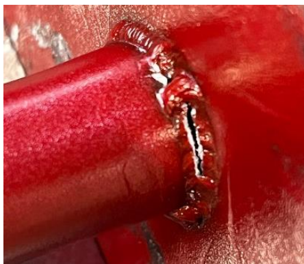
Slika 26. Kritična točka - mjesto zavara
