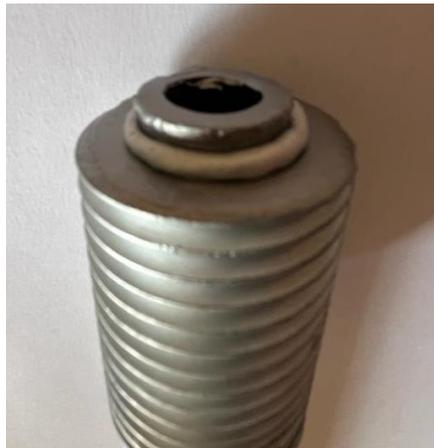
Slika 10. Rastopljeni vrh aluminijske cijevi
