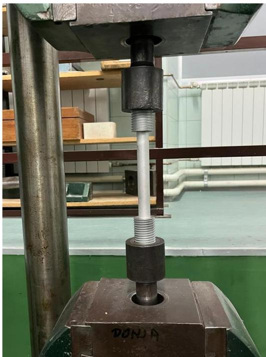
Slika 11. Prihvat uzorka na kidalici
