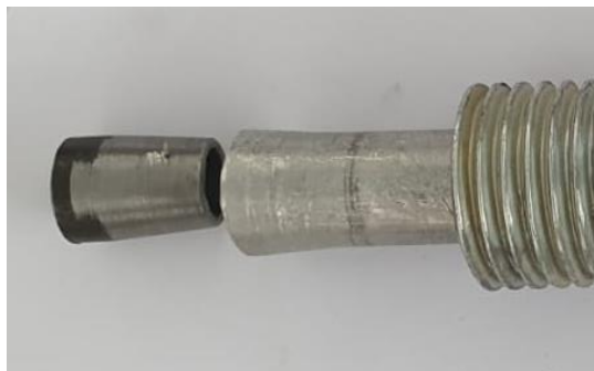
Slika 9. Umetanje čeličnog konusa u cijev
