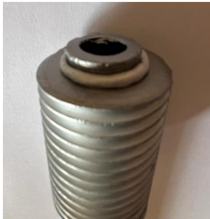
Slika 10. Rastopljeni vrh aluminijske cijevi
