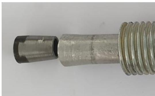
Slika 9. Umetanje čeličnog konusa u cijev
