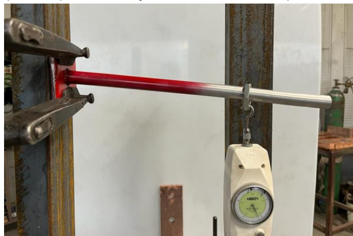
Slika 27. Puknuće zavarenog spoja cijevi \text{Ø}22 \times 2 mm, F=220 N
