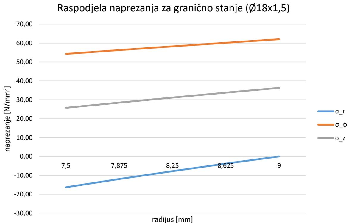
Slika 38. Raspodjela naprezanja za granično stanje,  $\varnothing 18 \times 1,5$
