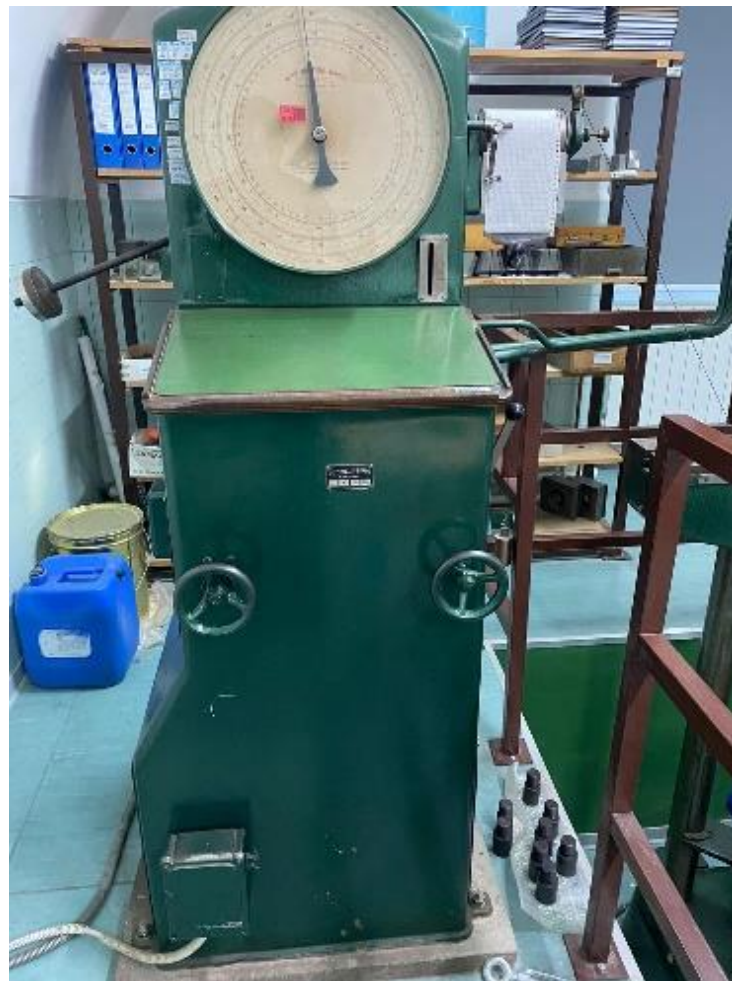
Slika 7. Kidalica Otto Wolpert-Werke, model U60
