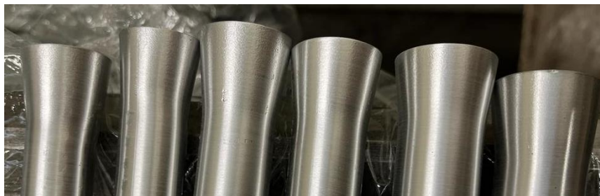
Slika 19. Prošireni krajevi cijevi na 15^\circ
