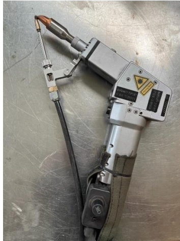
Slika 20. Laserski pištolj za zavarivanje
