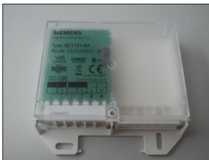
Slika 10. Analogno - modul DC 1131 - AA
