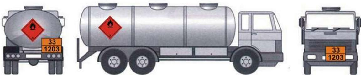
Slika 28. Označavanje vozila za transport zapaljivih tekućina
