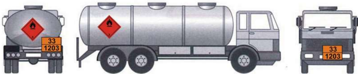
Slika 28. Označavanje vozila za transport zapaljivih tekućina
