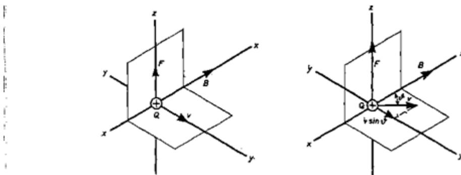
Slika br. 2.2 Sila na naboju koji se giba u homogenom magnetskom polju; (a) brzina  $v$  i indukcija  $B$  su međusobno okomite, (b) brzina  $v$  i indukcija  $B$  nisu međusobno okomite
