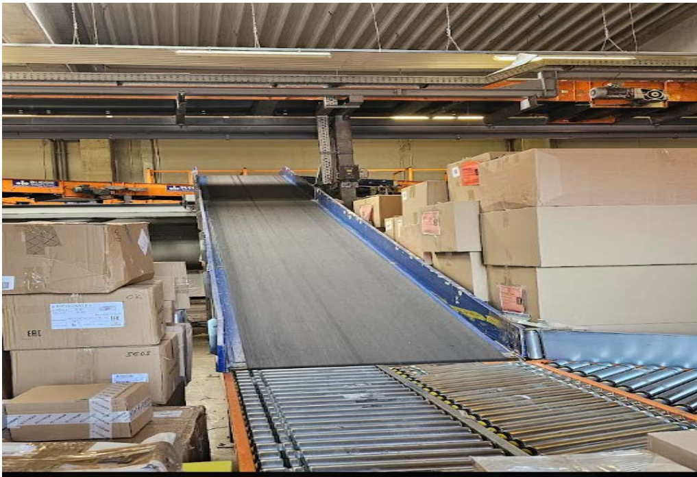
Slika 4 Traka za prienos paketa na međugradsko sortiranje [3]
