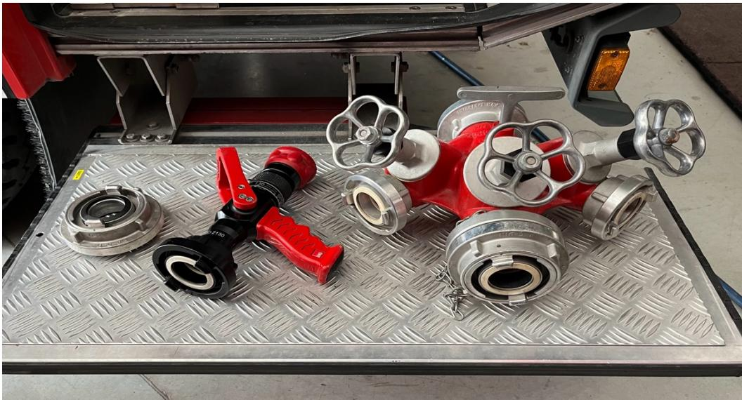
Sl.6. Armature za vodu iz navalnog vozila JVP Trogir (prijezna spojница, turbo mlaznica i razdjelnica).[4]
