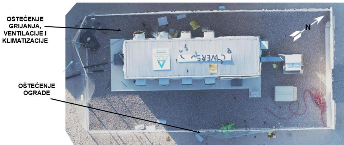
**Slika 14.** Postrojenje McMicken Battery Energy Storage nakon eksplozije [28]
