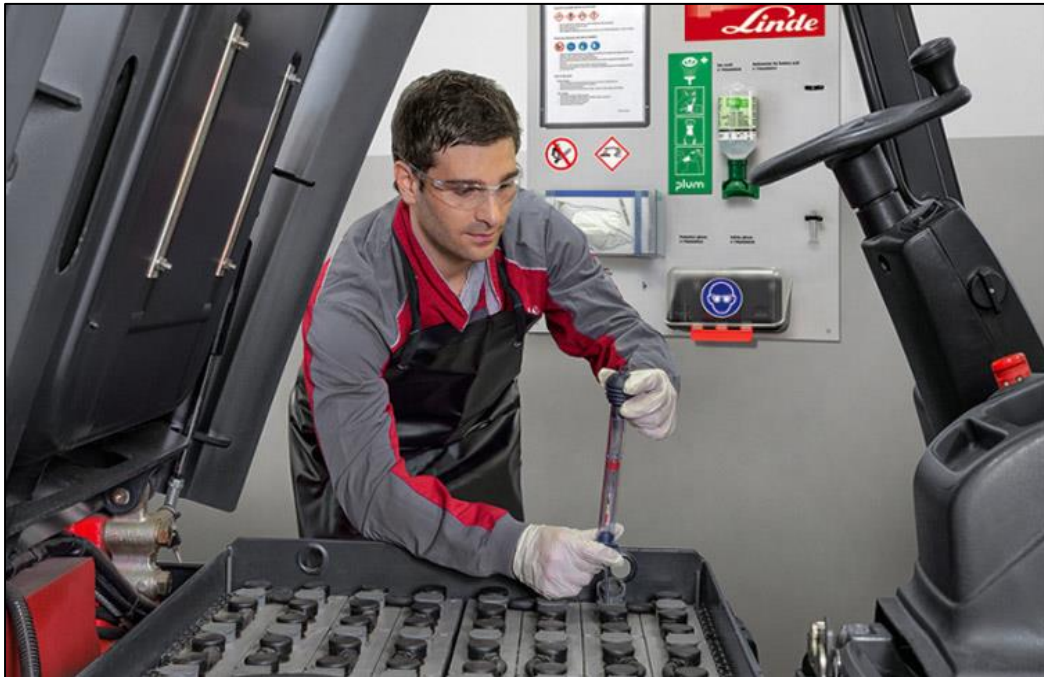
Slika 33. Održavanje akumulatora viličara
