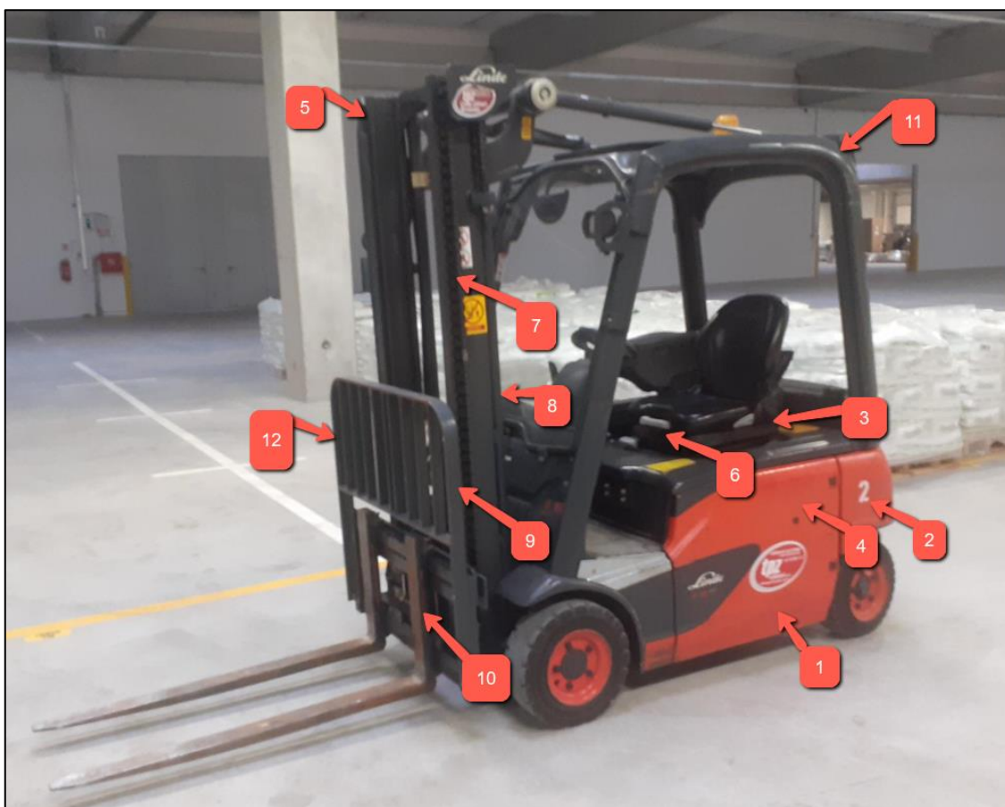
Sl.12. Dijelovi čeonog viličara
