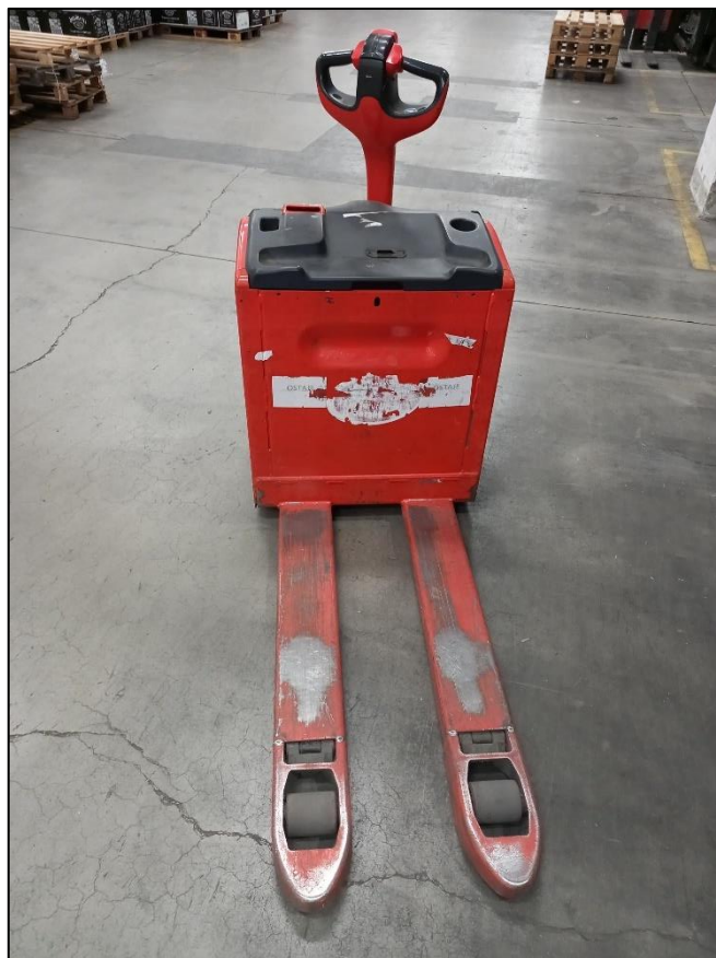
Sl. 9. Niskopodizni viličar
