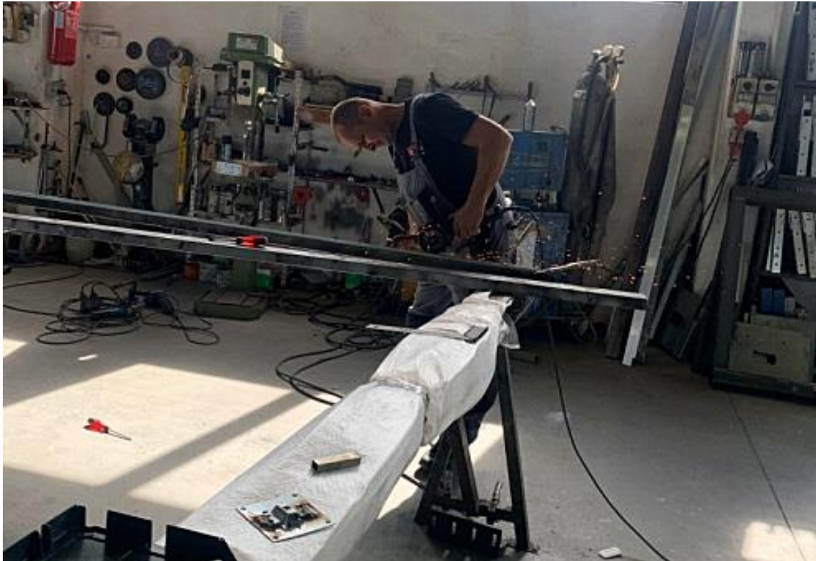
Slika 42. Primjer nepravilnog korištenja zaštitne odjeće
