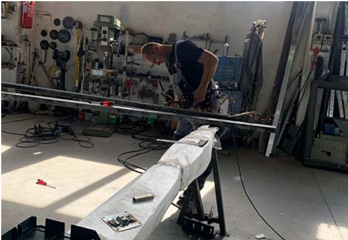
Slika 42. Primjer nepravilnog korištenja zaštitne odjeće
