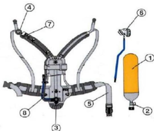
Slika 26. Prikaz dijelova aparata za zaštitu dišnih organa [26].
