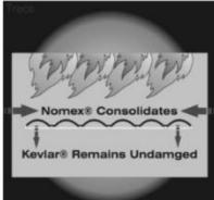
Ovaj sistem tkanine reagira na ekstremnu toplinu, koja se pojavljuje u bljeskovitom požaru (flash-fire). Ona uzrokuje da se konsolidira i namreška, dok mreža Kevlar® Nomex-a ostaje neoštećena.
