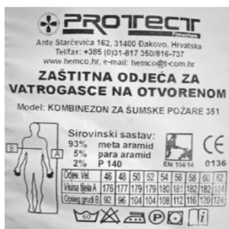
Slika 27. Oznake na vatrogasnoj odjeći [5].
