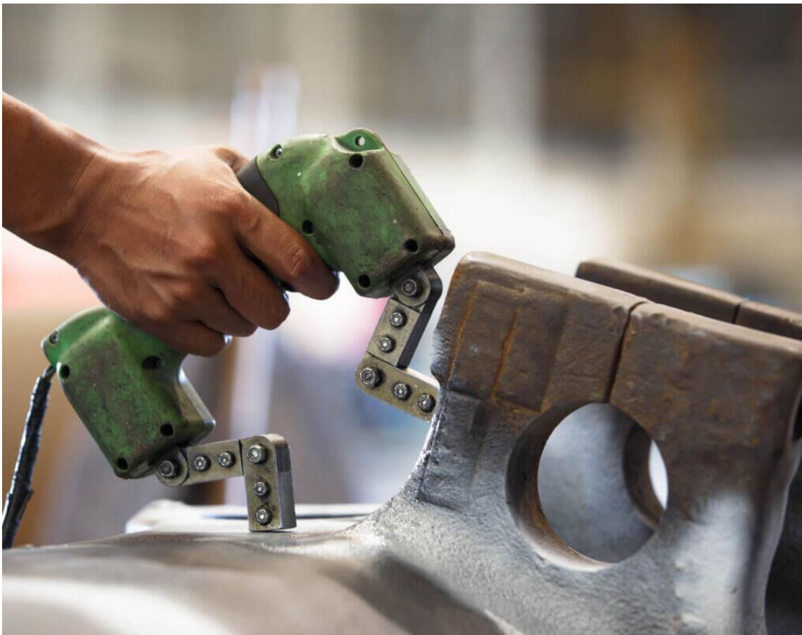
Slika 22. Ispitivanje elektromagnetskim ručnim jarmom [9]
