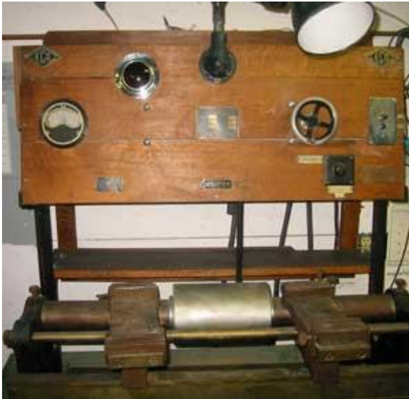
Slika 1. Elektromagnetski uređaj za ispitivanje materijala iz 1928. godine, kojeg je izgradila kompanija Equipment and Engineering Company Ltd. (ECO) iz Stranda u Engleskoj. [2]
