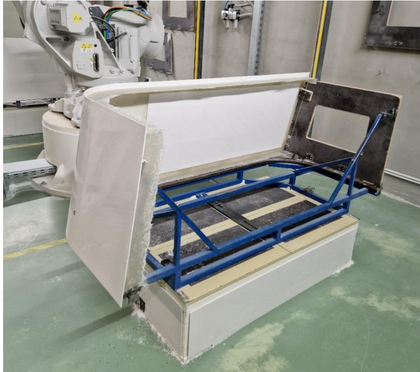
Slika 19. Obloga Wall Corner L na robotskom negativu.
