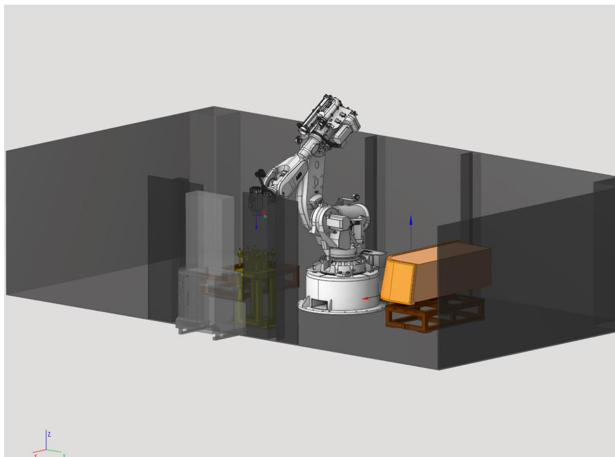
**Slika 28. Model čelije robota i model Wall Corner L obloge u SprutCAM-u.**
