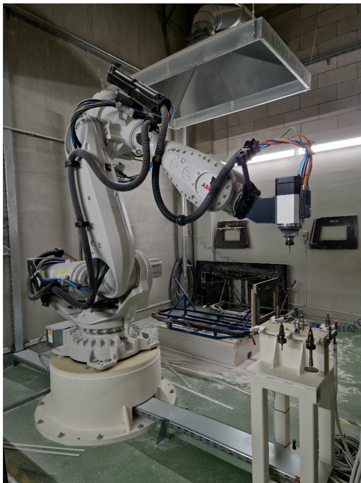
Slika 6. Artikulirani robot za obrezivanje u tvornici Aquaestil.
