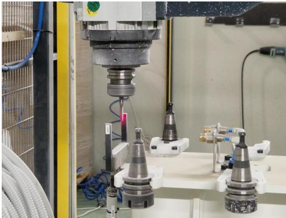
Slika 35. Umjeravanje alata
