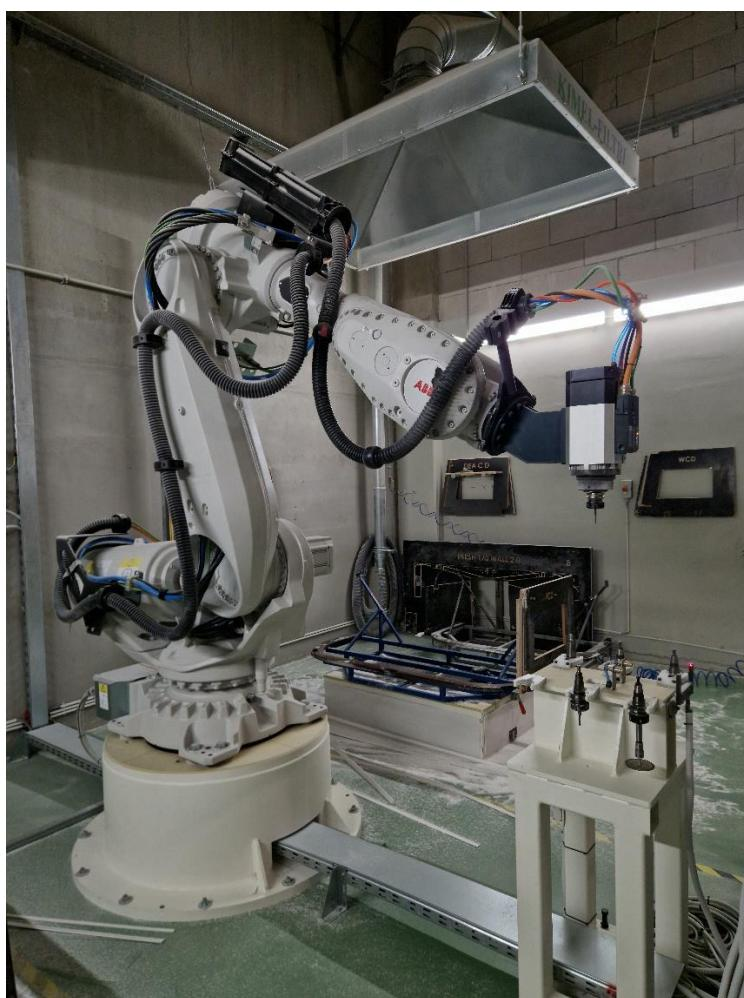
**Slika 6. Artikulirani robot za obrezivanje u tvornici Aquaestil.**
