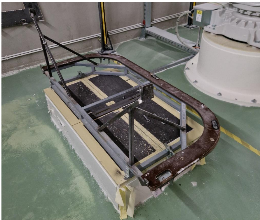
Slika 18. Negativ za obrezivanje pozicioniran na radnom stolu.
