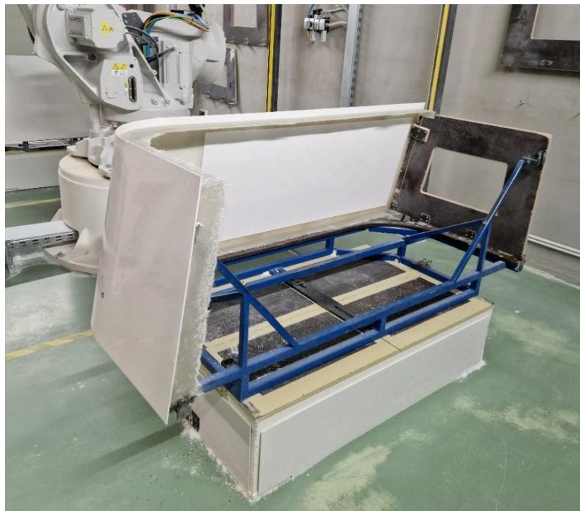
Slika 19. Obloga Wall Corner L na robotskom negativu.
