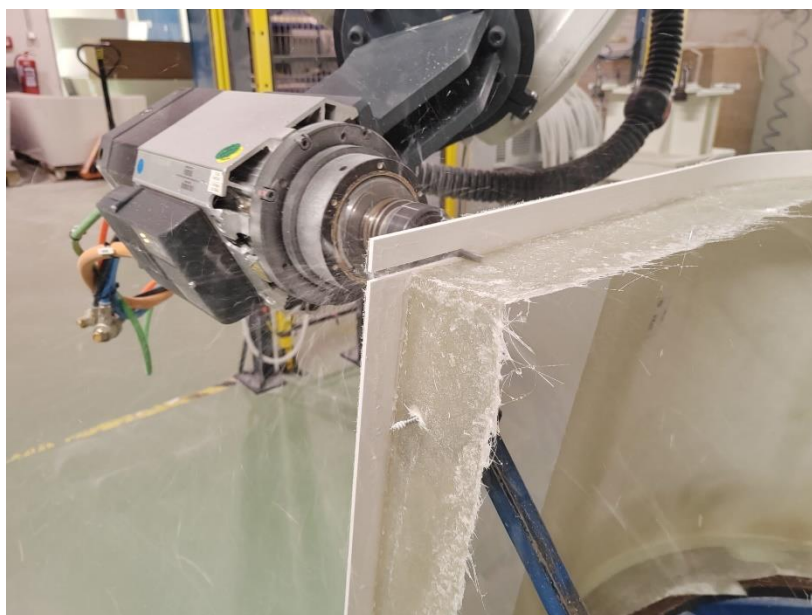
Slika 7. Proces robotskog obrezivanja obloge.
