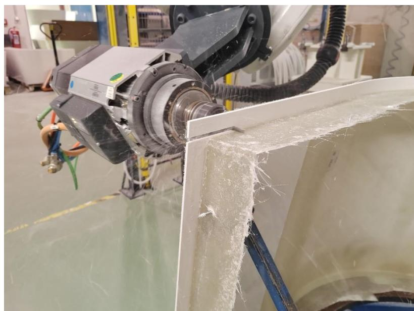
**Slika 7. Proces robotskog obrezivanja obloge.**
