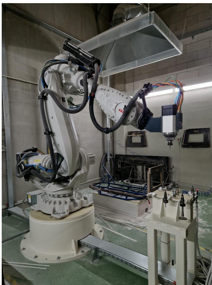
Slika 6. Artikulirani robot za obrezivanje u tvornici Aquaestil.
