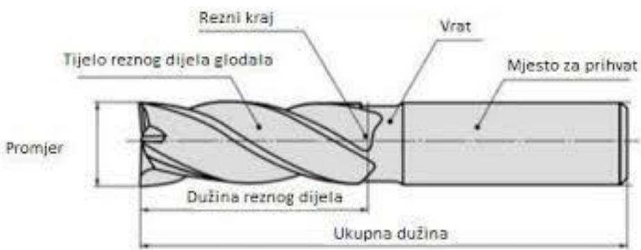
**Slika 8. Tijelo reznog alata [10].**
