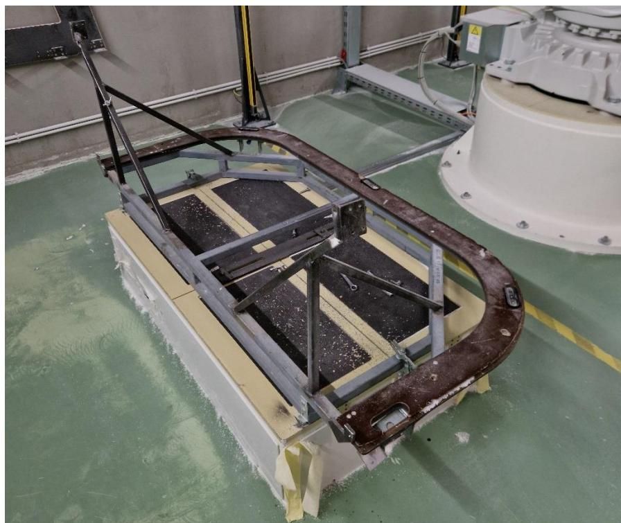
**Slika 18. Negativ za obrezivanje pozicioniran na radnom stolu.**
