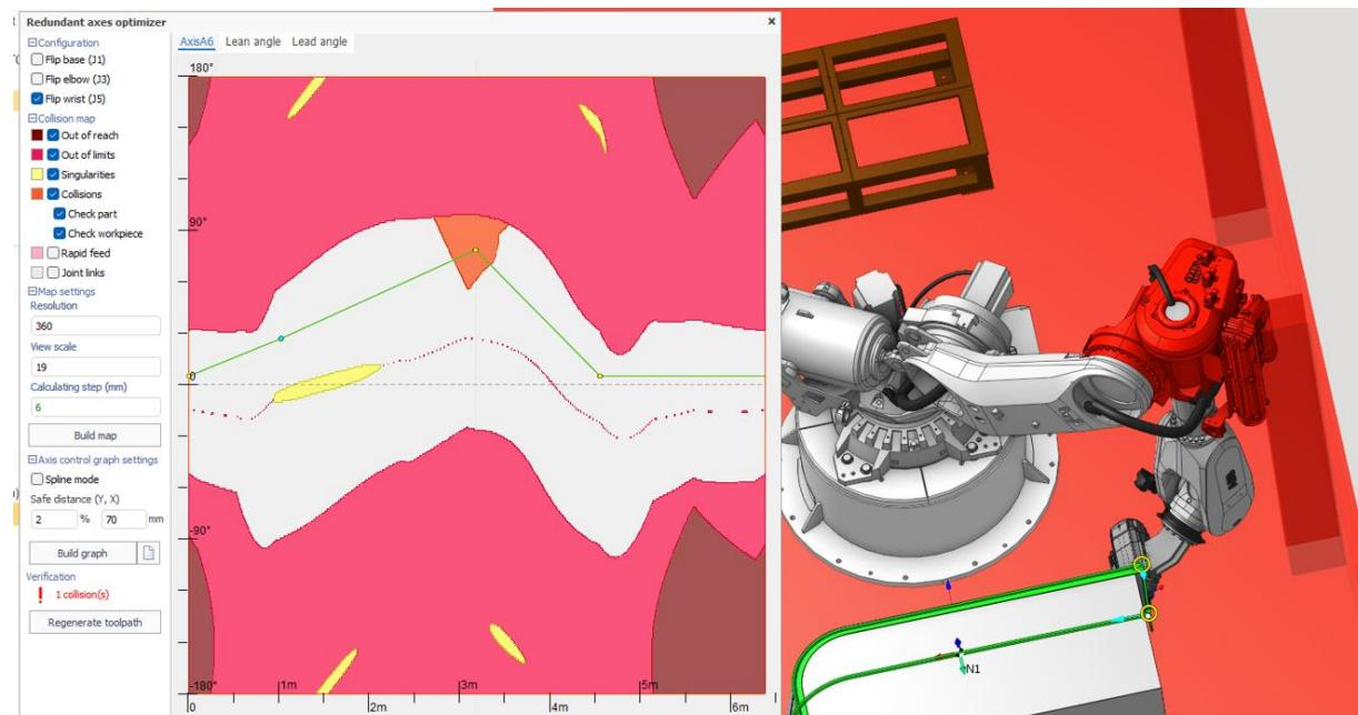
Slika 33. Detekcija sudara robota sa čelijom.
