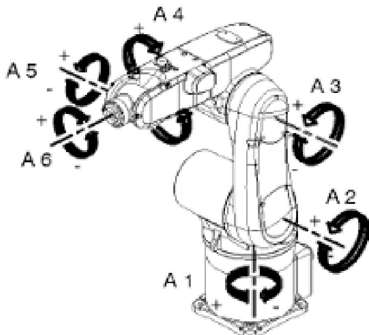
Slika 5. Artikulirana robotska ruka sa 6 stupnjeva slobode [7].
