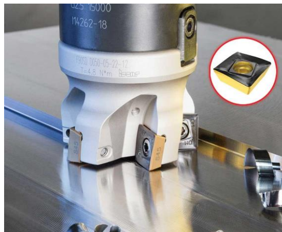
Slika 9. Alat sa umetnutom reznom oštricom [12].
