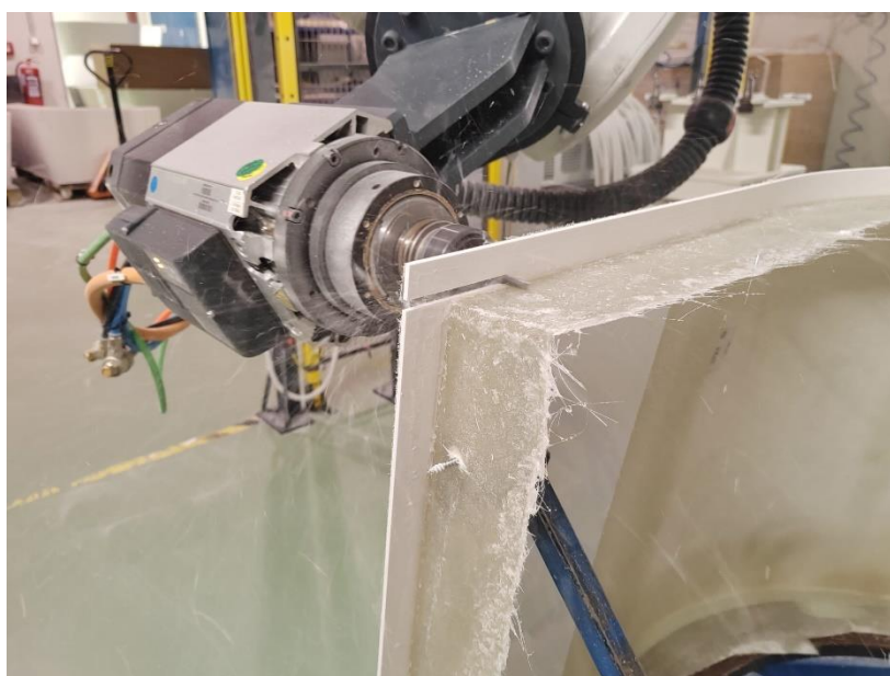
Slika 7. Proces robotskog obrezivanja obloge.
