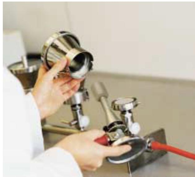
**Slika 3.** Sterilizacija metalnih dijelova membranskog filtra (Sartorius, 2015).
