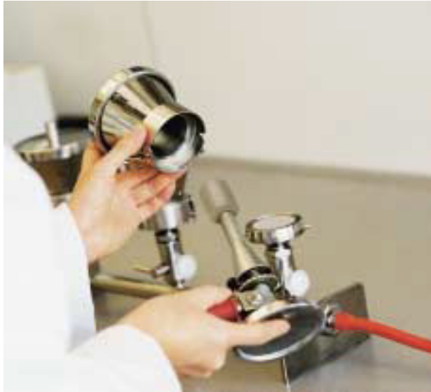
Slika 3. Sterilizacija metalnih dijelova membranskog filtra (Sartorius, 2015).
