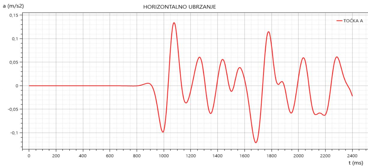
Slika 34 Graf horizontalnog ubrzanja (Os y) (vlastiti izvor)
