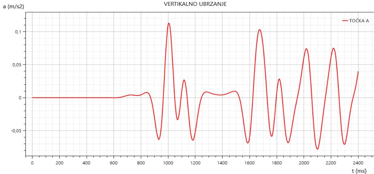
Slika 33 Graf Vertikalnog ubrzanja (Os z) (vlastiti izvor)
