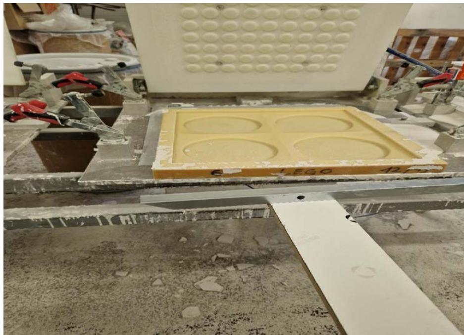
Slika 15 Fiksiran profil sa točkom položen na drvenu polici ispred kalupa te je postavljen mobitel na tu polici (vlastiti izvor)
