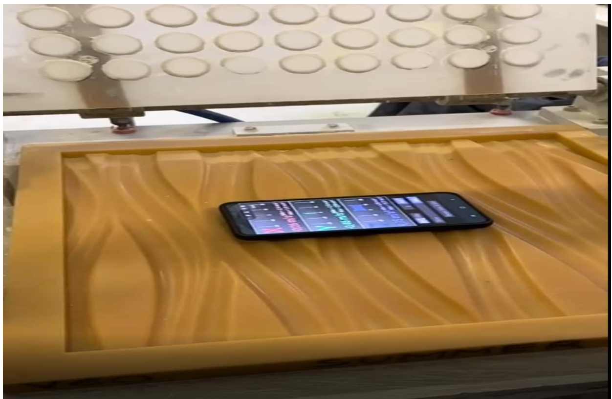
Slika 14 Mjerenje akcelerometrom (vlastiti izvor)
