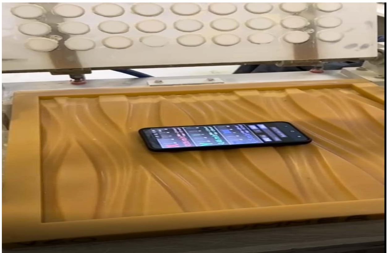
Slika 14 Mjerenje akcelerometrom (vlastiti izvor)
