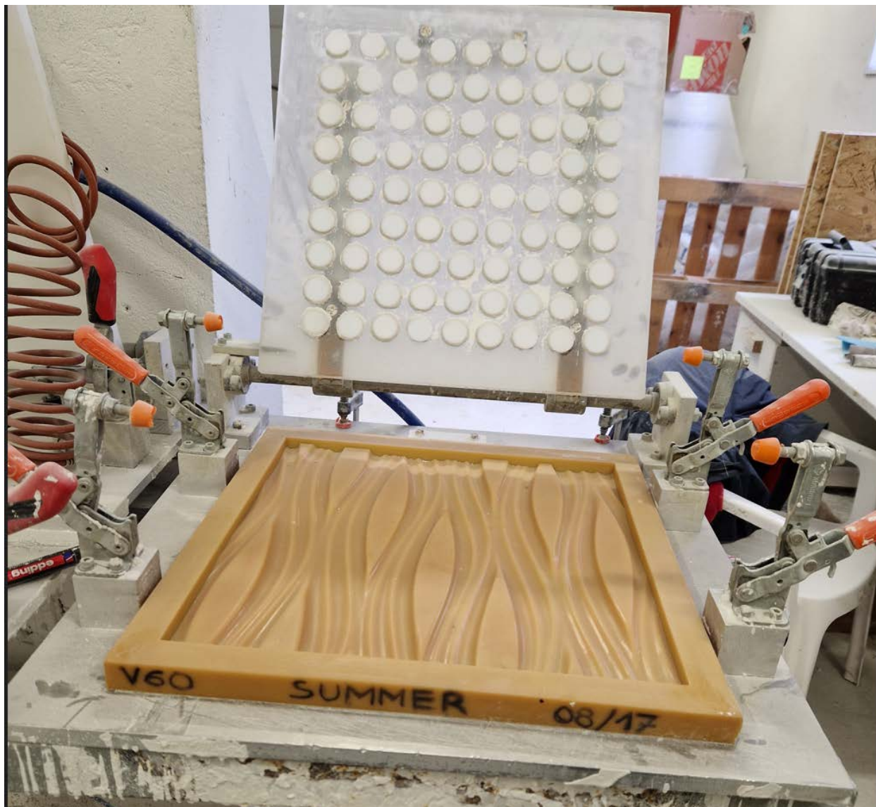
Slika 8 Polazemo kalup na vibro-stol (vlastiti izvor)
