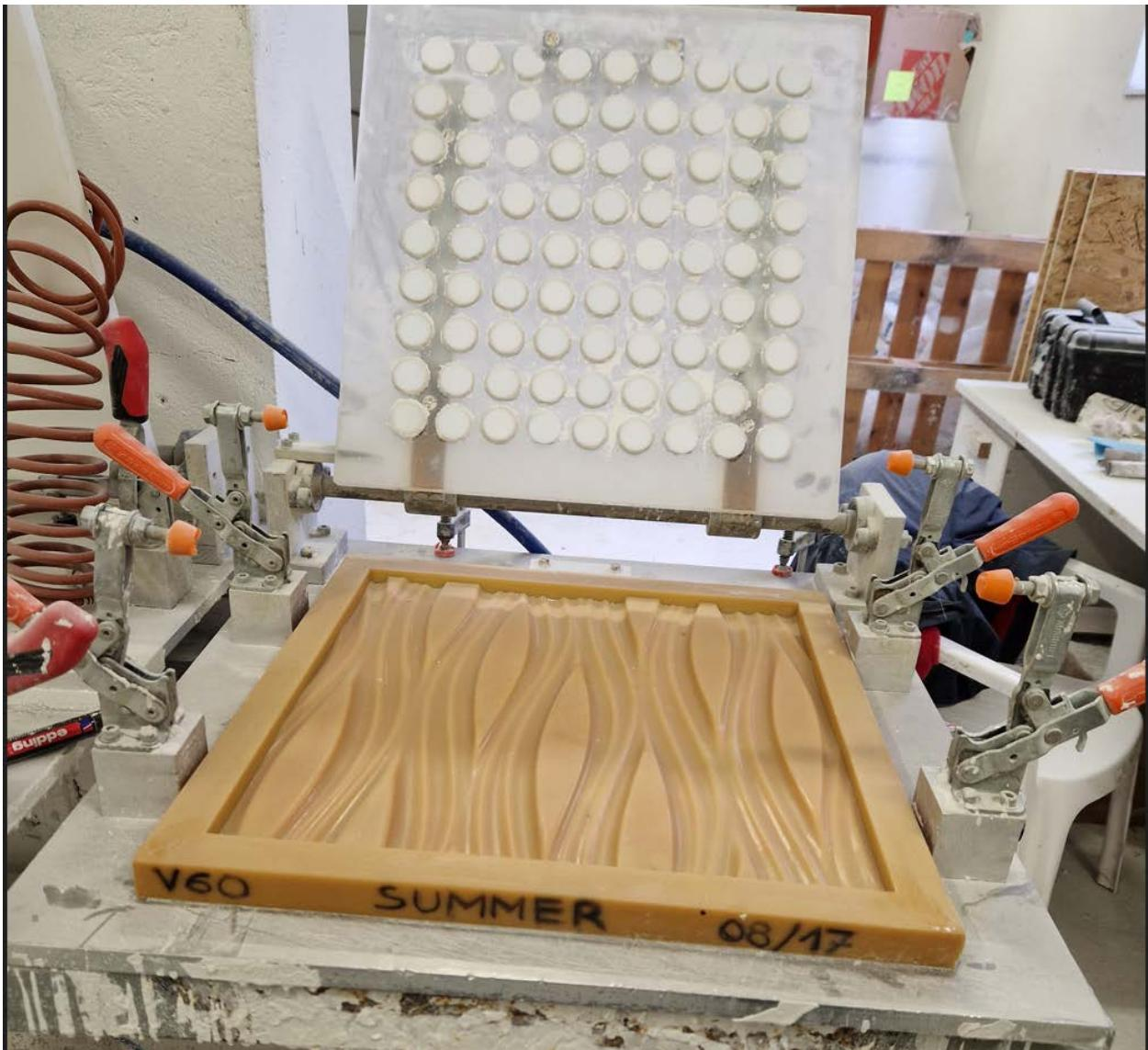
Slika 8 Polažemo kalup na vibro-stol (vlastiti izvor)
