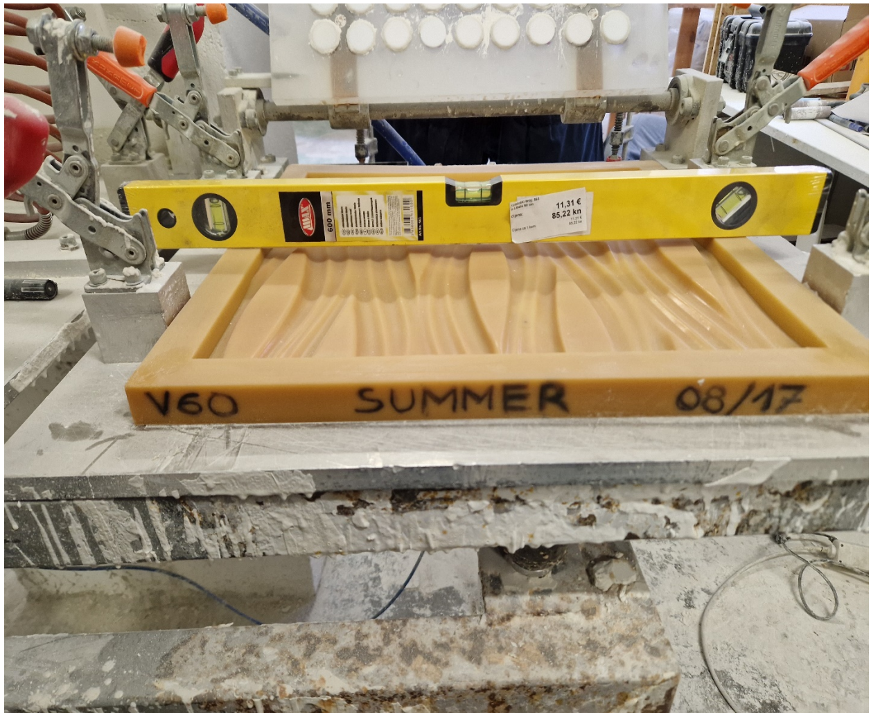
Slika 9 Sa libelom provjeravamo da li je površina ravna (vlastiti izvor)
