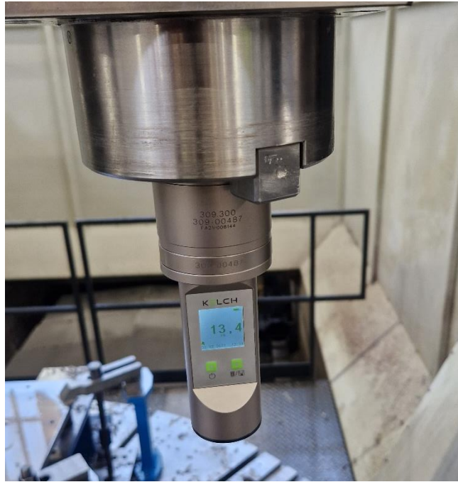
Slika 20. Provjera sile stezanja glavnog vretena
