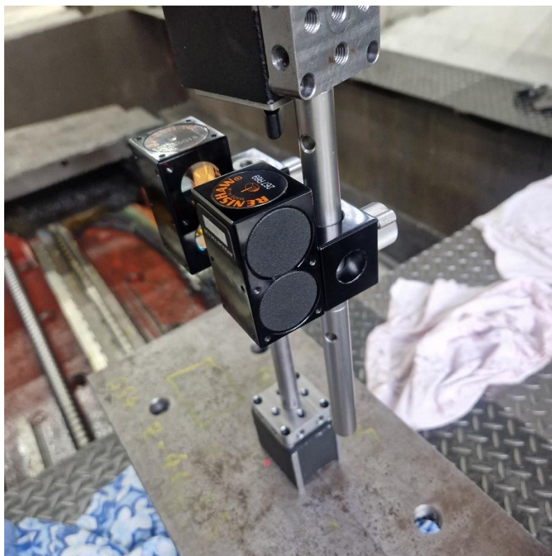
Slika 61. Interferometri montirani na vretenište i „X“ os
