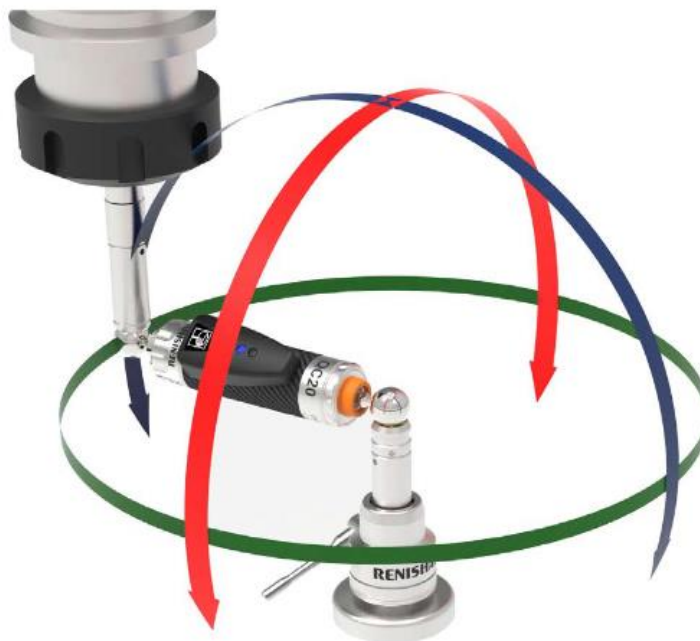
Slika 39. Shematski prikaz rada QC20 – W [10]
