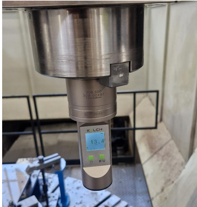
Slika 20. Provjera sile stezanja glavnog vretena
