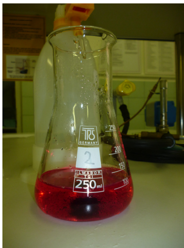
Slika 6. Izgled uzorka nakon završene titracije (Izvor: Matanović, Đ.)
