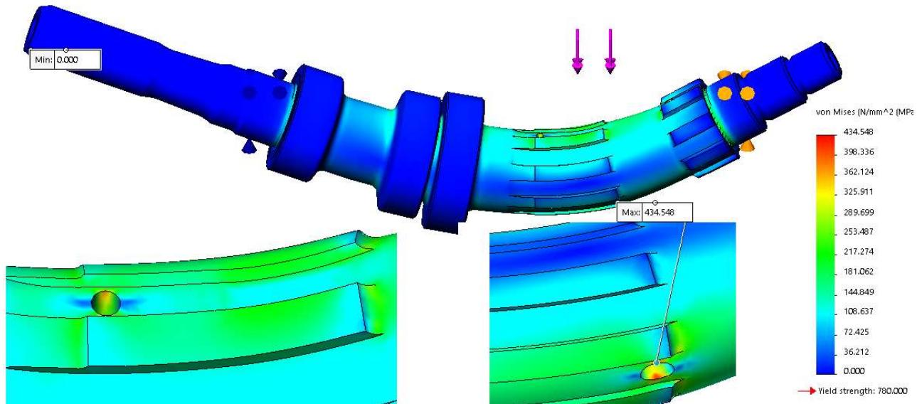
Slika 45. Naprezanja u V stupnju prijenosa
