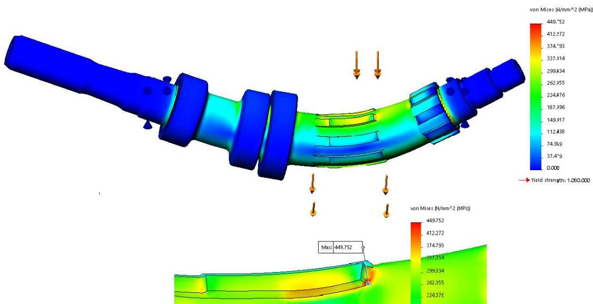
Slika 51. Naprezanja sa  $K_1$  bez aksijalnih prvrta
