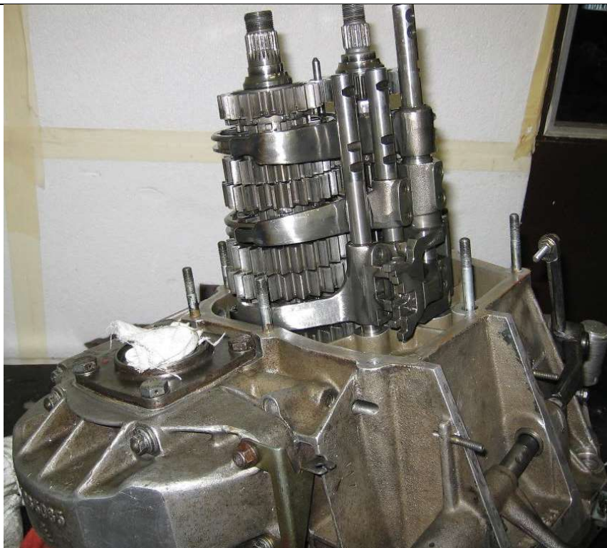
Slika 35. Sklop Mjenjača Lancia Delta Integrale
