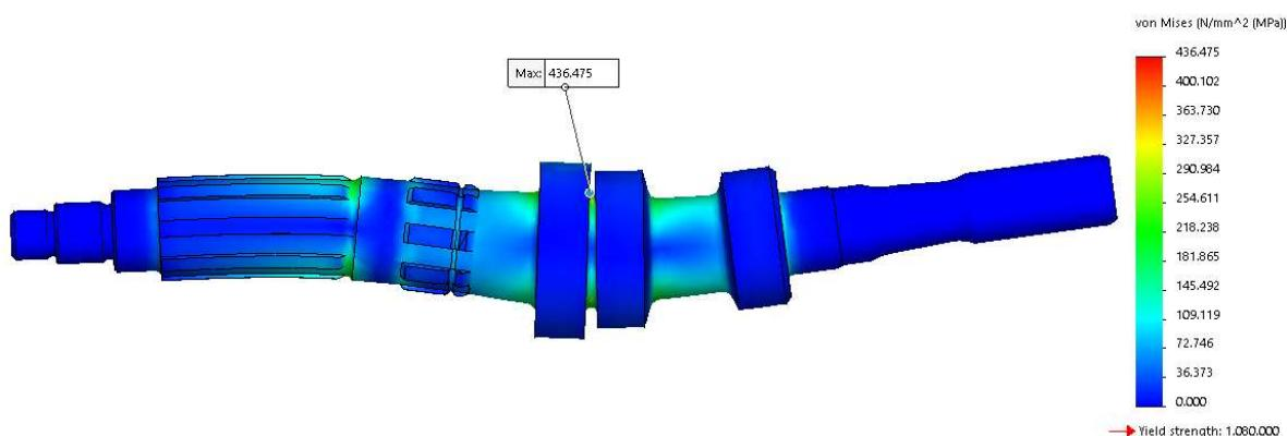
**Slika 67. Analiza naprezanja u III stupnju prijenosa**
