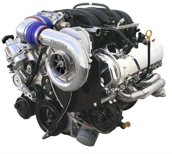
Slika 12. Centrifugalni turbo kompresor [9]
