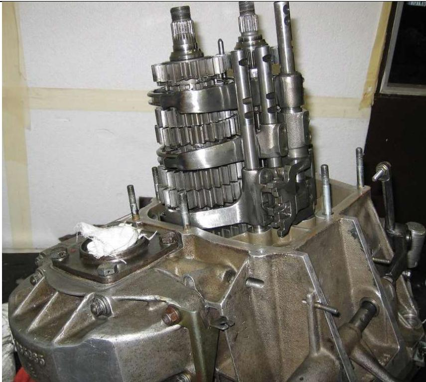
Slika 35. Sklop Mjenjača Lancia Delta Integrale
