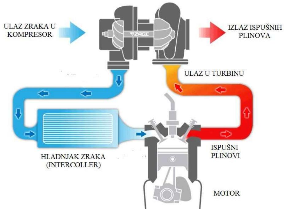
Slika 8. Princip rada konvencionalnog turbopunjajuća [6]
