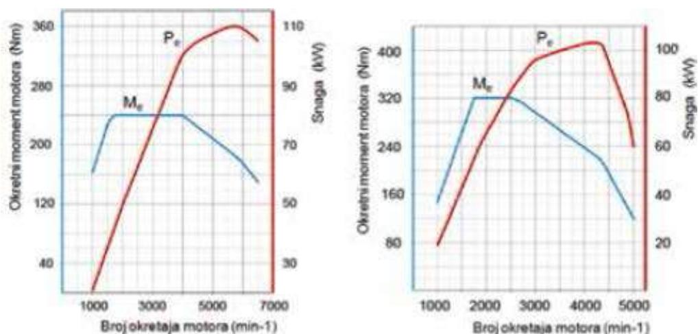
$P_e$  – efektivna snaga [W] ,  $M_e$  – efektivni moment motora [Nm]
