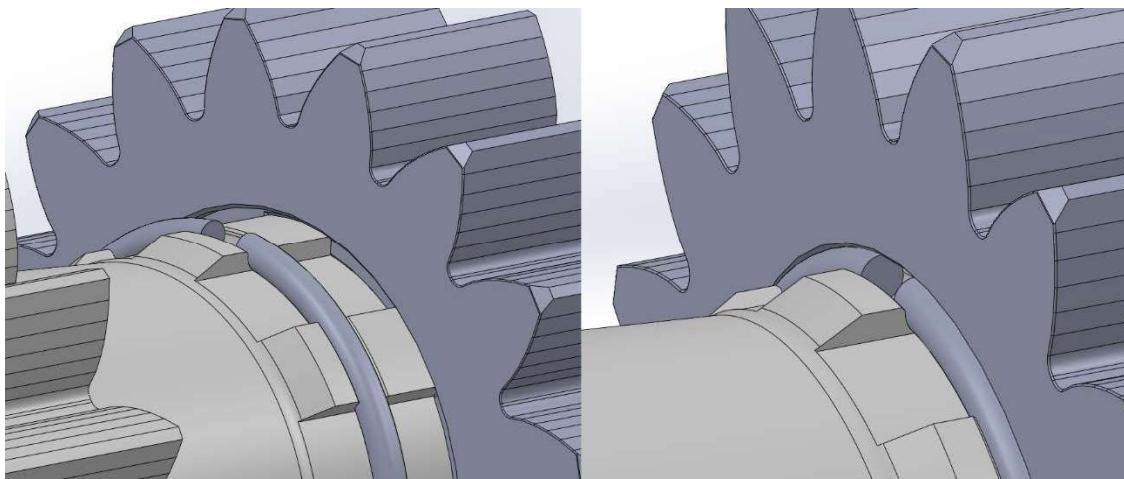
Slika 60. Ugradnja aksijalnog prstena na zupčaniku IV stupnja
