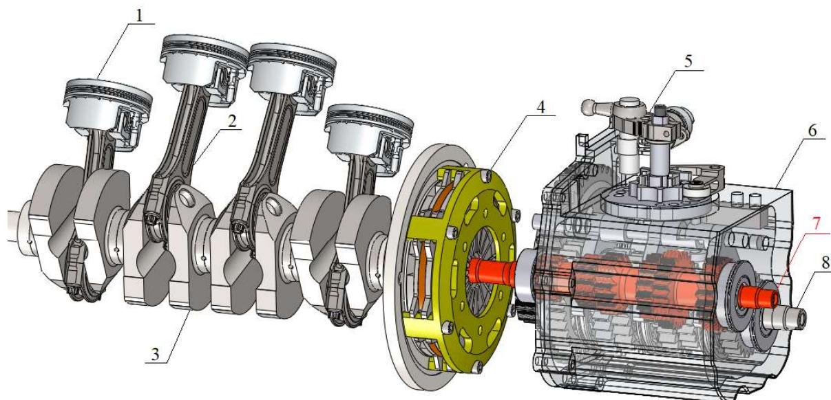
**Slika 24. Dijelovi prijenosa snage – Motor, Spojka i Mjenjač**
