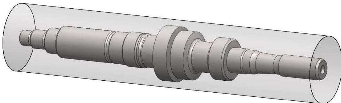
Slika 64. Obrada tokarenjem
