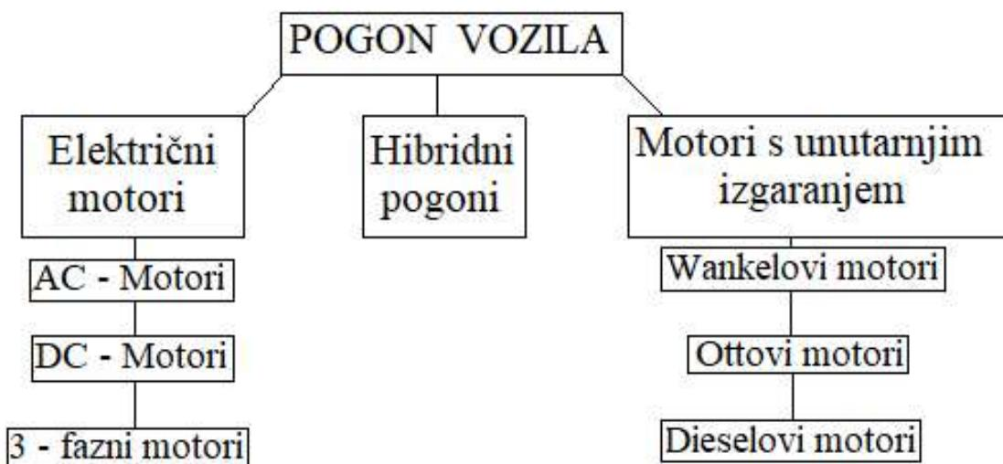
Slika 2. Vrste pogonskih motora [5]
