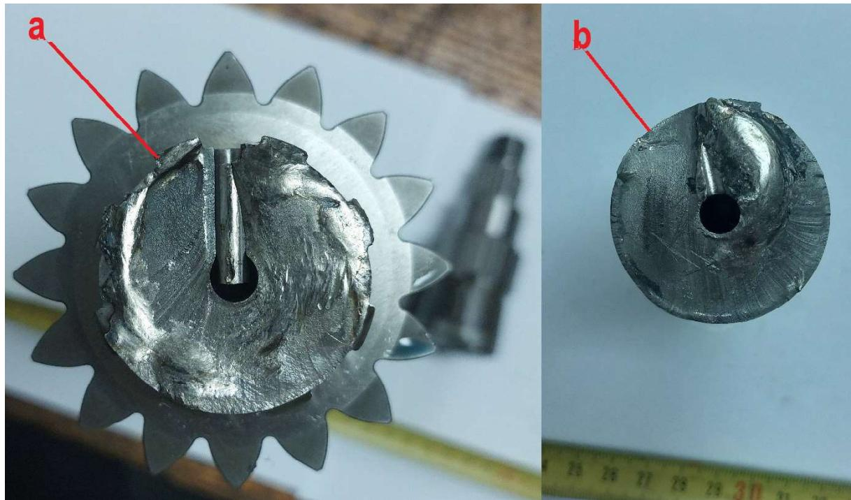
Slika 41. Površine loma na pogonskom vratilu a) i b)
